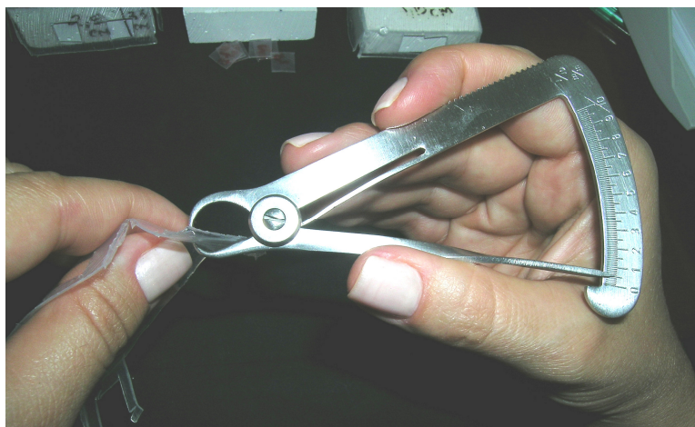
Figura 1 - Medida da espessura do silicone (0,5 mm) na superfície lateral do silicone, depois de plastificado sobre o bloco de gesso, com o uso de um espessímetro
