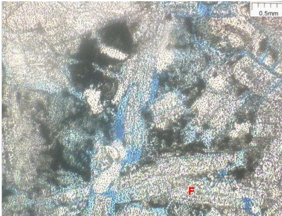
Figura 26 – Fotomicrografia do solo residual 3 (SR3), em que (F) são feldspatos calco-sódicos apresentando um microfraturamento.
