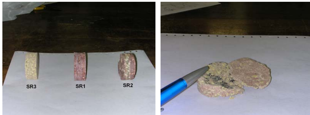
Figura 15 – Amostras com fraturas sub-horizontais dispostas aleatoriamente.
