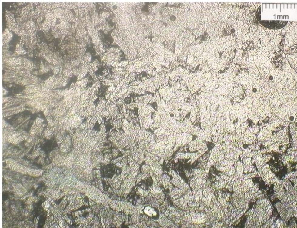
Figura 27 – Fotomicrografia do solo residual 2 (SR2), mostrando os feldspatos calco-sódicos completamente argilizados.
