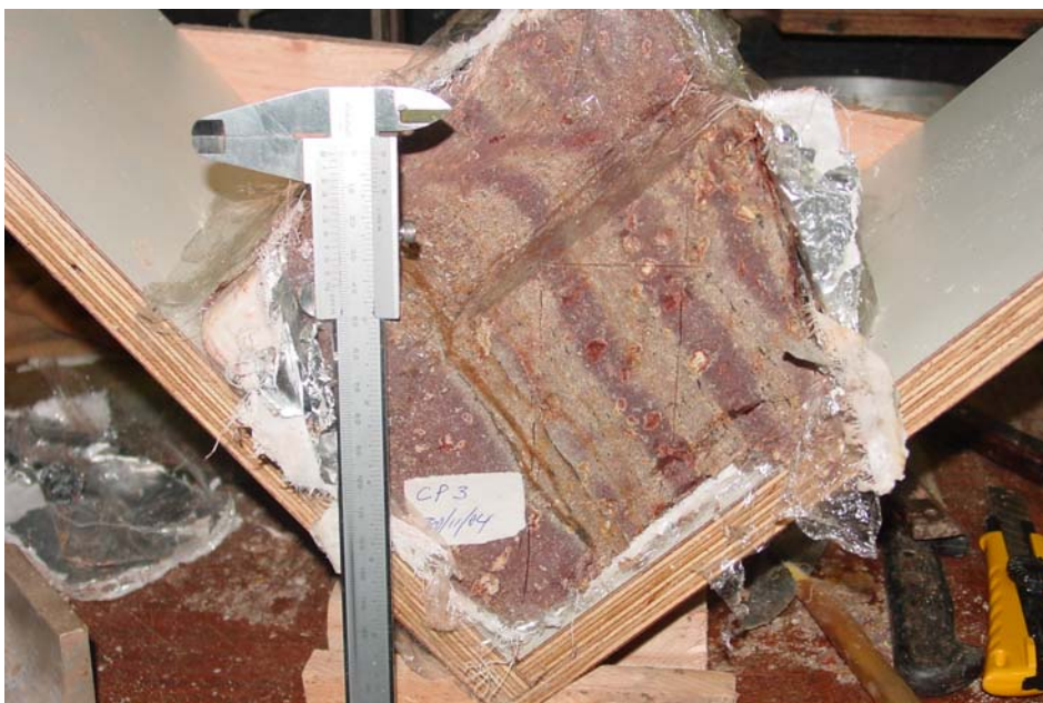
Figura 21 – Moldagem de amostras do SR2, com fraturas com inclinação de 45°.
