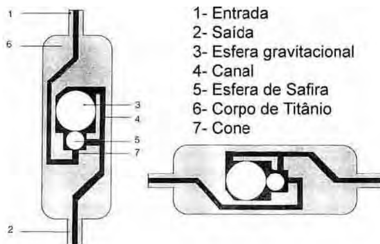
Fig. 2.13 – Válvula Miethke ShuntAssistant, que, na posição vertical é fechada pelo efeito da gravidade e, na horizontal, encontra-se aberta; ilustrada por Aschoff et al. (1999).
