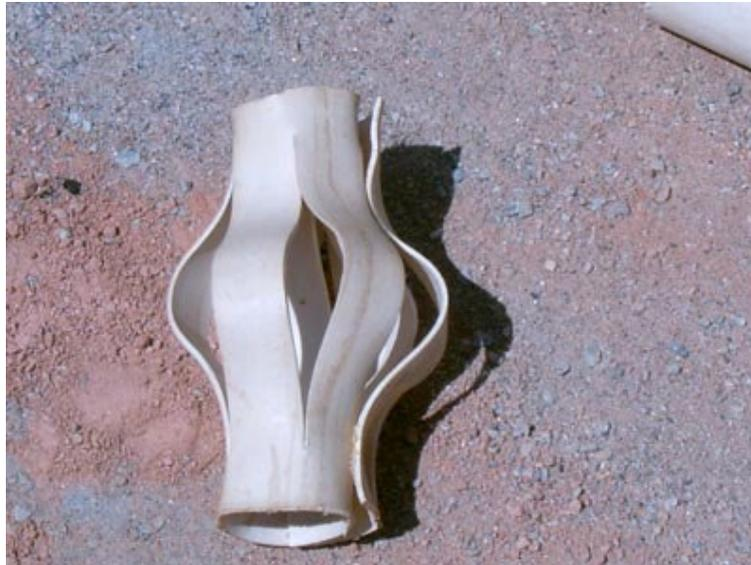
Figura 3.18 – Detalhe dos centralizadores confeccionados na obra.
