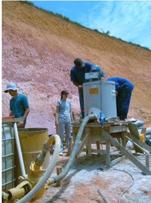
Figura 3.22 – Detalhe do misturador sobre a plataforma de madeira.
