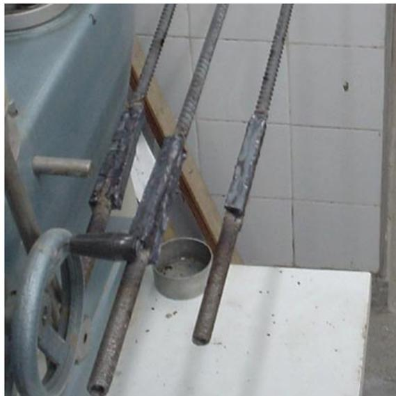
Figura 3.11 – Detalhe das chapinhas metálicas soldadas às barras de aço.
