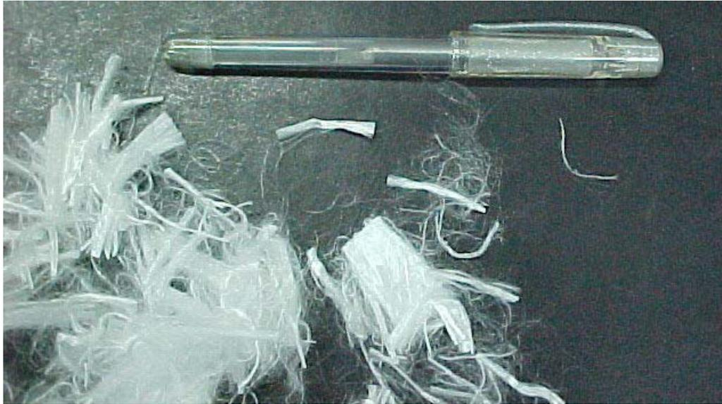
Figura 3.5 – Fibras de polipropileno multifilamentos.
