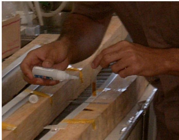
Figura 3.12 – Processo de colagem dos *strain gages*.
