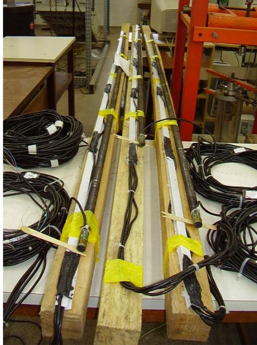
Figura 3.15 – Barras e perfis instrumentados prontos para serem transportados.
