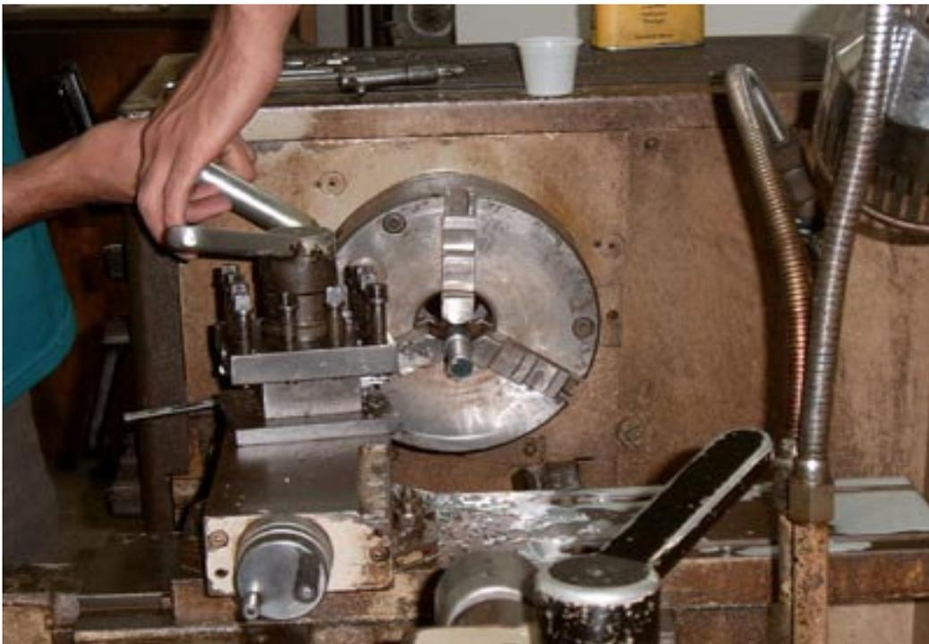
Figura 3.10 – Usinagem das barras de aço nervuradas.
