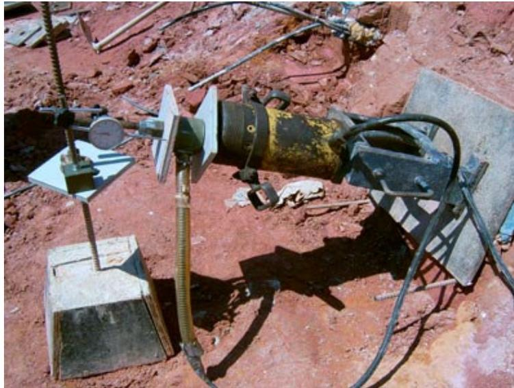
Figura 3.31 – Montagem típica do ensaio de arrancamento.
