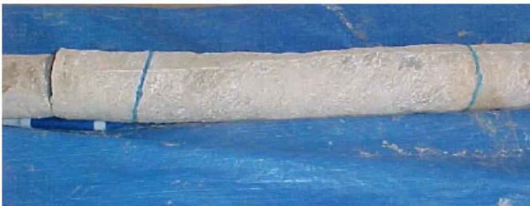
Figura 4.8 – Detalhe das fissuras do grampo GP21 (MAGALHÃES, 2005).
