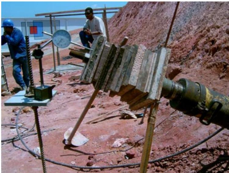
Figura 3.32 – Detalhe do extensômetro apoiado sobre o conjunto de placas metálicas.
