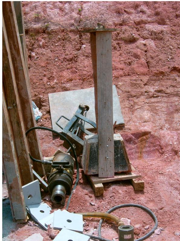
Figura 3.35 – Situação do aparato de ensaio após a ruptura abrupta da barra de aço do grampo GP31.
