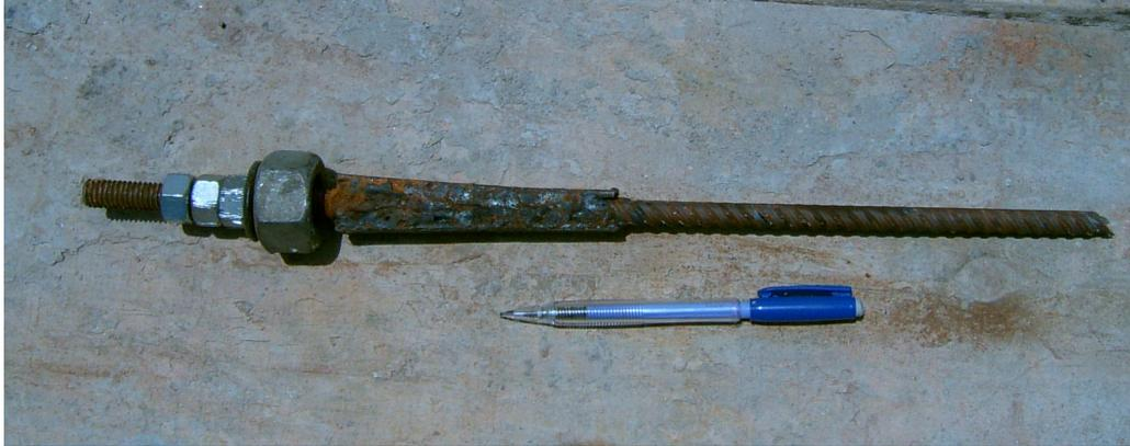
Figura 3.34 – Detalhe da barra de aço de 10mm com sinais de estrição no trecho rompido.
