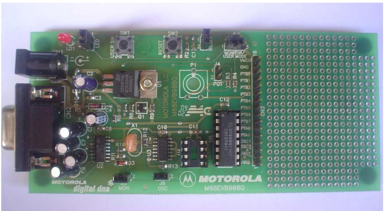
Figura 4.3 – Foto da placa de desenvolvimento M68EVB908Q®.
