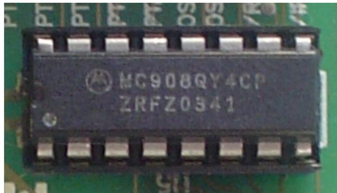
Figura 4.1 – Foto do Microcontrolador MC68HC908QY4<sup>®</sup>
