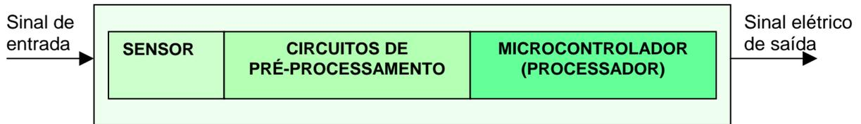
Figura 3.1. Concepção básica de um sensor inteligente.
