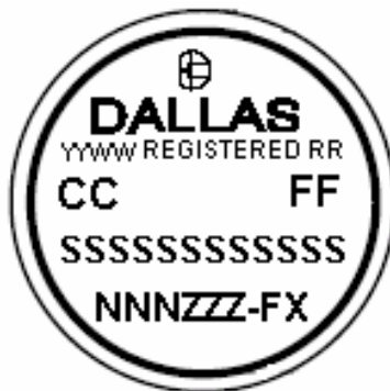
Figura 2.4: Descrição das informações gravadas na parte superior do iButton .
