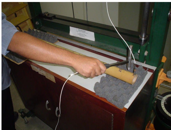
Figura 3.12 – Obtenção da FRF Pontual.
