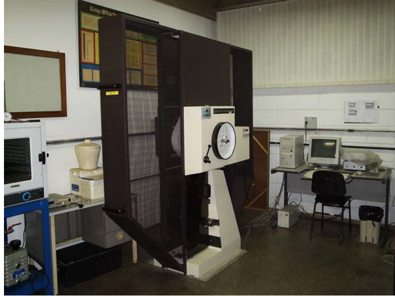
Figura 27 – Foto geral da máquina Charpy Instron Wolpert.
