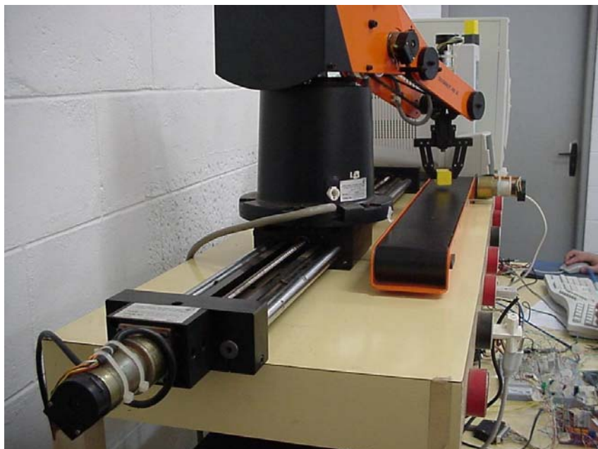
Figura 2.2: Foto do braço onde se pode visualizar a esteira e sua base deslizante pertencentes ao robô
