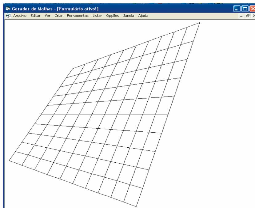
Figura A.60 - Malha na forma de quadrilátero, com elementos retangulares.
