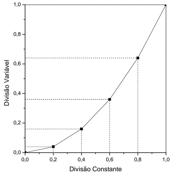
Figura 3.4 - Divisão utilizando a função polinomial não linear,  $n = 2$ .
