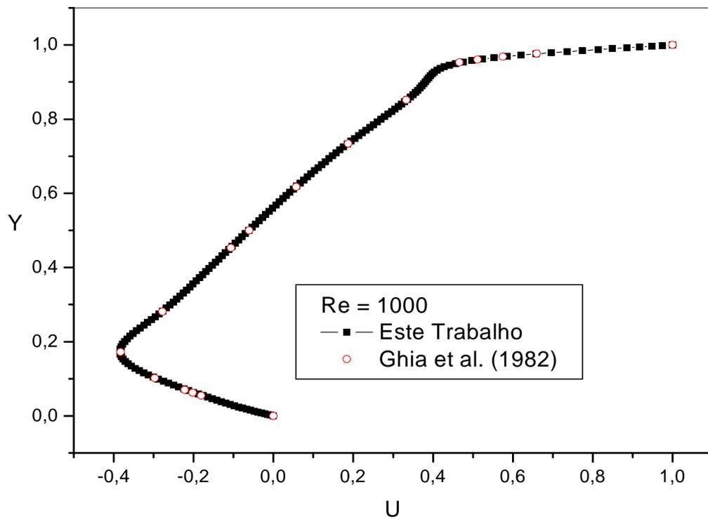
Figura 7.5 - Componente de velocidade U para  $X = 0,5$  e  $Re = 1000$ .
