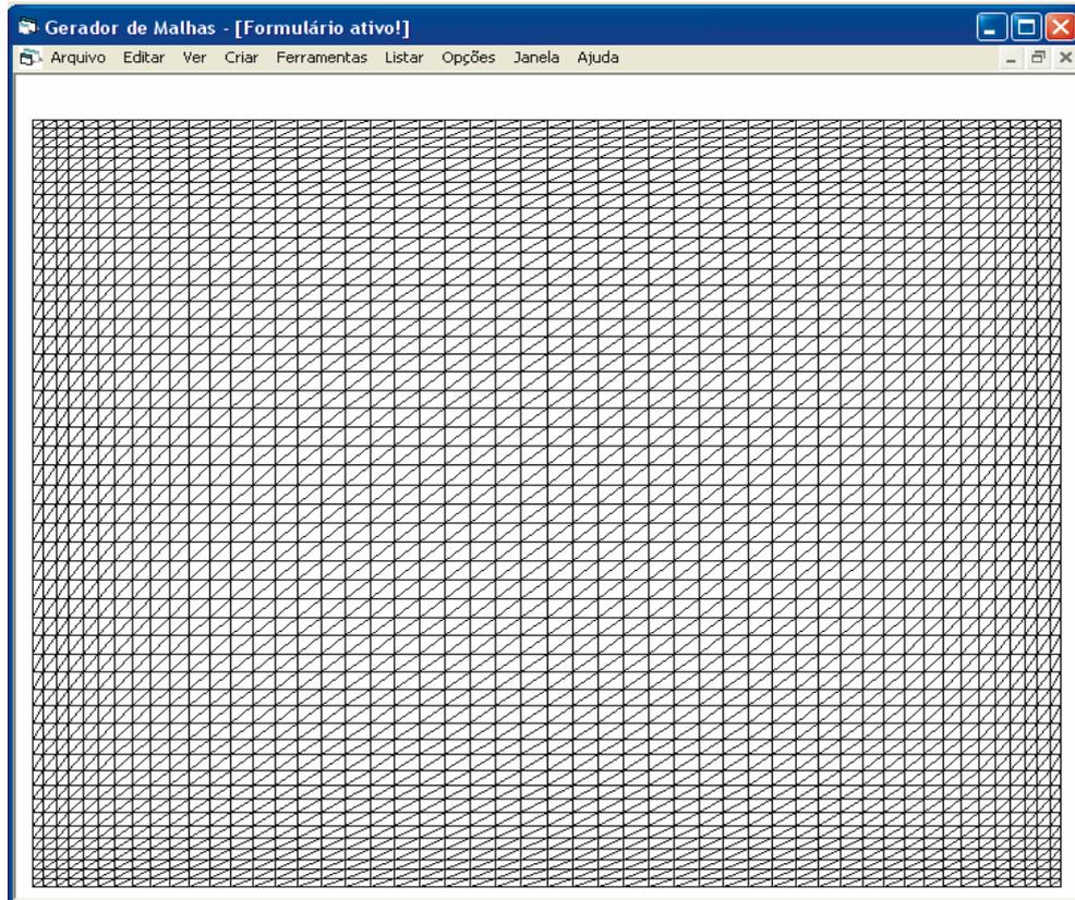
Figura 6.6 - Malha com elementos triangulares refinada junto às paredes.
