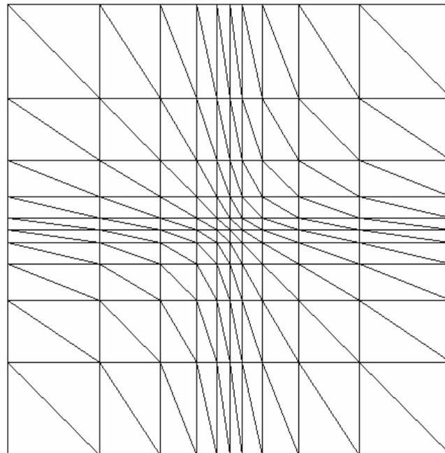
Figura 3.17 - Refino de elementos triangulares no centro,  $c = 2.5$ .
