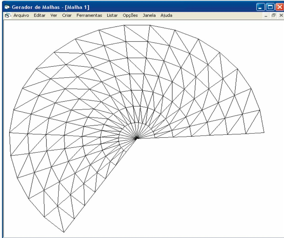
Figura 6.14 - Malha na forma de setor circular com elementos triangulares.
