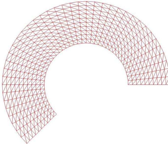
Figura 4.4 - Setor de coroa subdividido em elementos triangulares.
