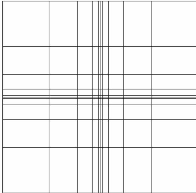
Figura 3.18 - Refino de elementos retangulares no centro,  $c = 2.9$  em.
