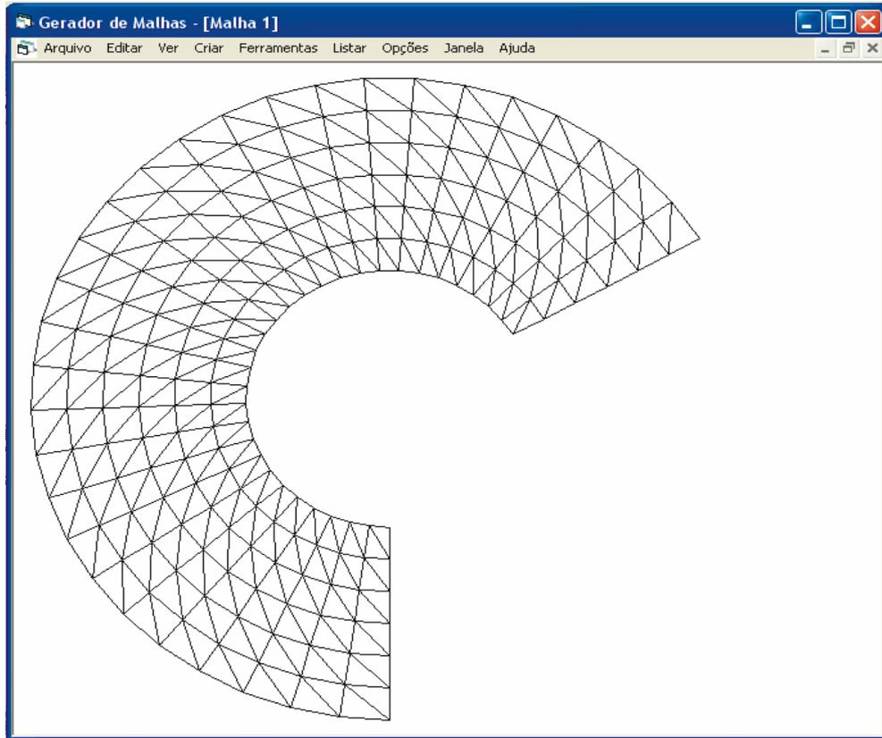
Figura 6.16 - Malha na forma de setor de coroa com elementos triangulares.
