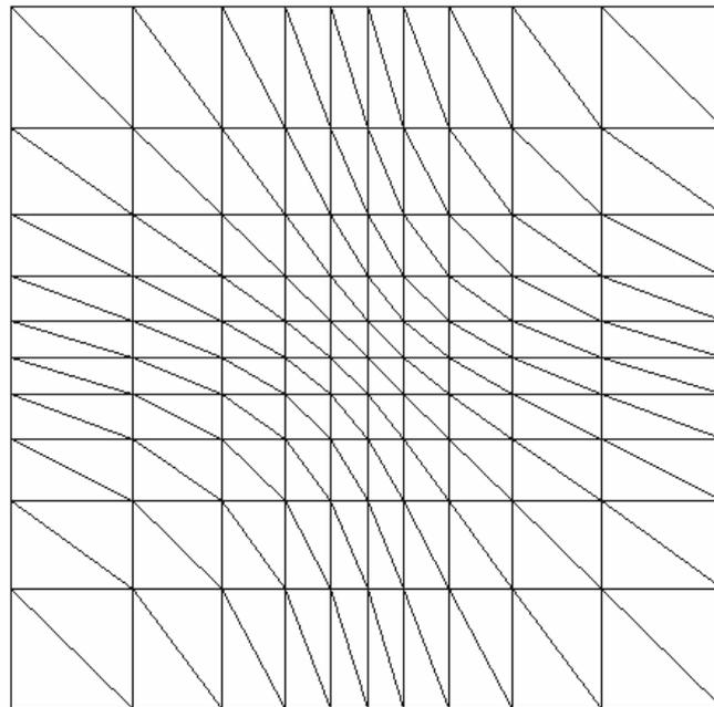
Figura 3.15 - Refino de elementos triangulares no centro,  $c = 2$ .
