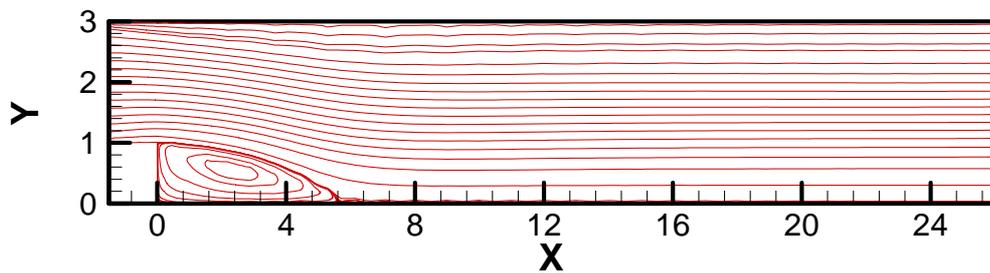
Figura 7.21 - Funções de corrente num canal com expansão em degrau, para  $Re = 400$ .
