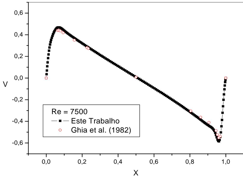
Figura 7.12 - Componente de velocidade V para  $Y = 0,5$  e  $Re = 7500$ .
