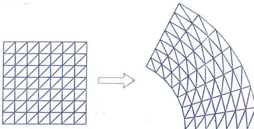
Figura 4.3 - Exemplo de mapeamento um quadrado unitário para um setor de coroa.
