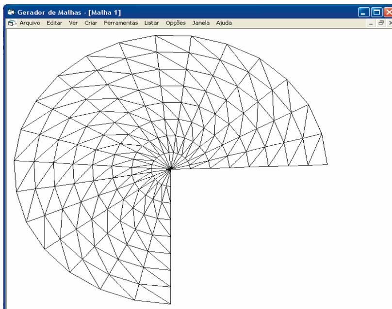
Figura A.63 - Malha no formato setor de círculo, com elementos triangulares.
