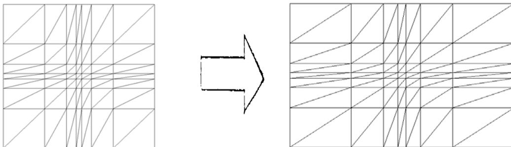
Figura 4.1 - Mapeamento de malha retangular, com elementos triangulares:
