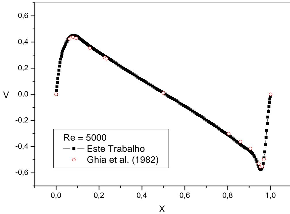
Figura 7.10 - Componente de velocidade V para  $Y = 0,5$  e  $Re = 5000$ .
