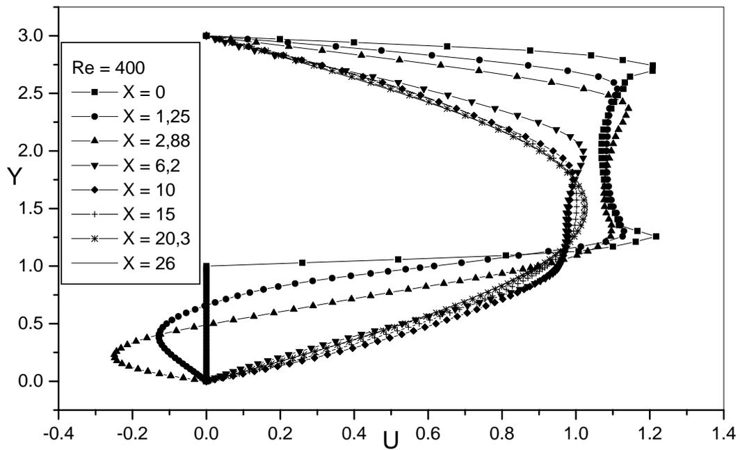
Figura 7.20 - Velocidade axial em várias posições ao longo do canal,  $Re = 400$ .
