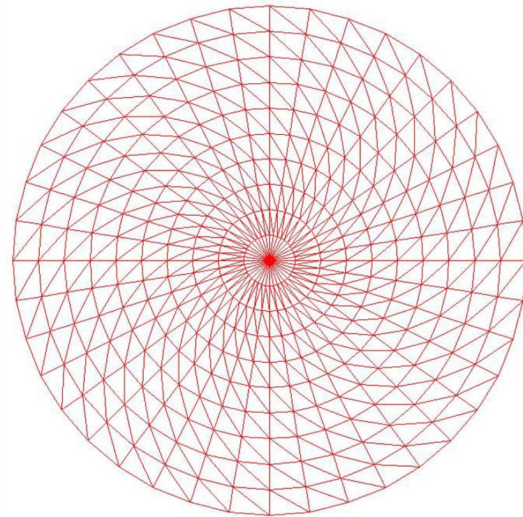
Figura 4.7 - Círculo subdividido em elementos triangulares.
