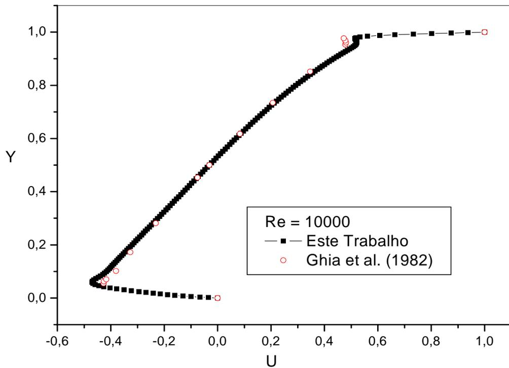
Figura 7.13 - Componente de velocidade U para  $X = 0,5$  e  $Re = 10000$ .
