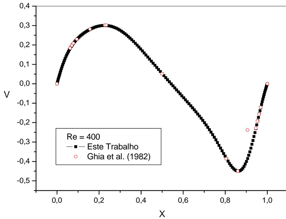
Figura 7.4 - Componente de velocidade V para  $Y = 0,5$  e  $Re = 400$ .
