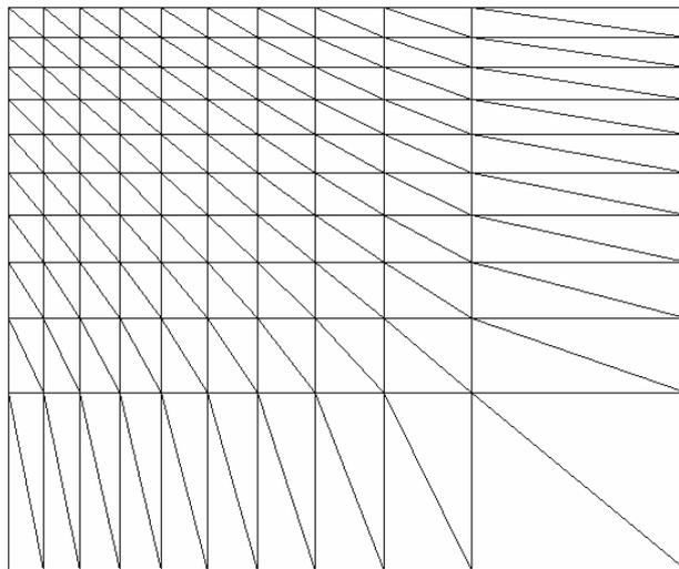
Figura 3.25 - Refino dos elementos triangulares no canto superior esquerdo.
