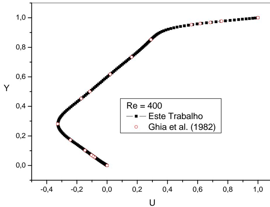
Figura 7.3. – Componente de velocidade U para  $X = 0,5$  e  $Re = 400$ .
