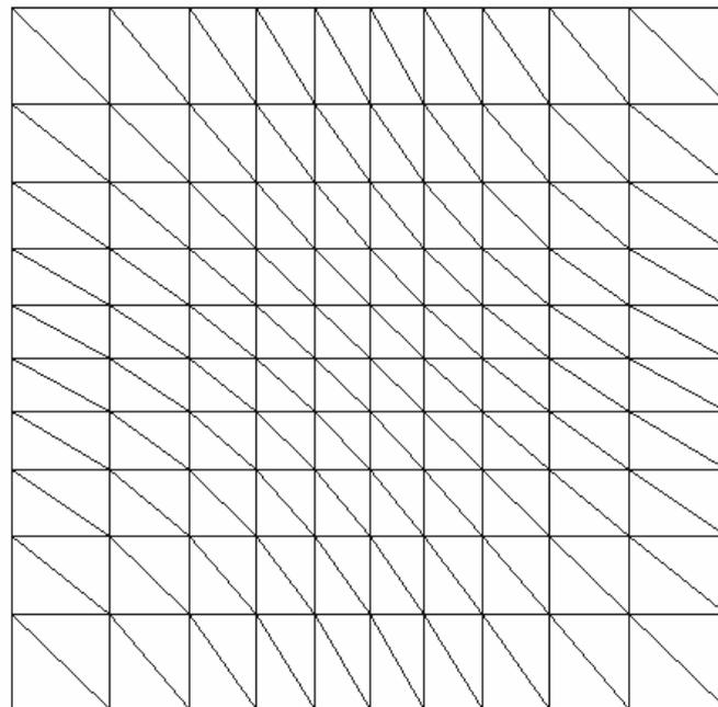
Figura 3.13 - Refino de elementos triangulares no centro,  $c = 1.5$ .
