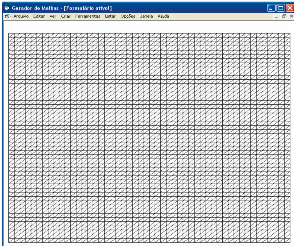
Figura 6.1 - Malha uniforme com elementos triangulares.
