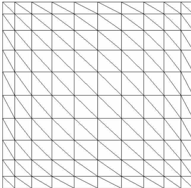
Figura 3.23 - Refino dos elementos triangulares nas laterais,  $c = 0.5$ .
