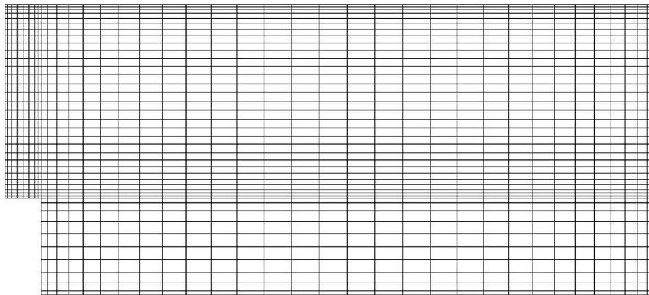
Figura 7.17 - Ilustração de uma malha no canal com expansão.
