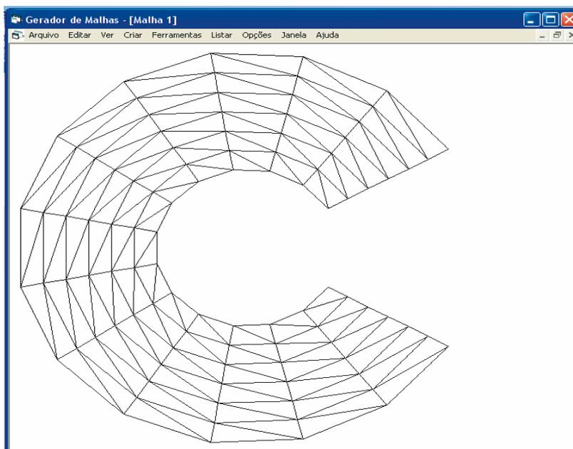
Figura A.67 - Malha no formato setor de coroa, com elementos triangulares.
