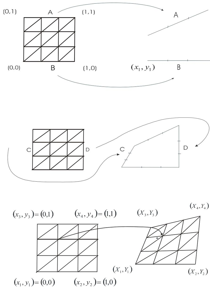
Figura 4.8 - Sequência de mapeamento de um quadrilátero convexo.
