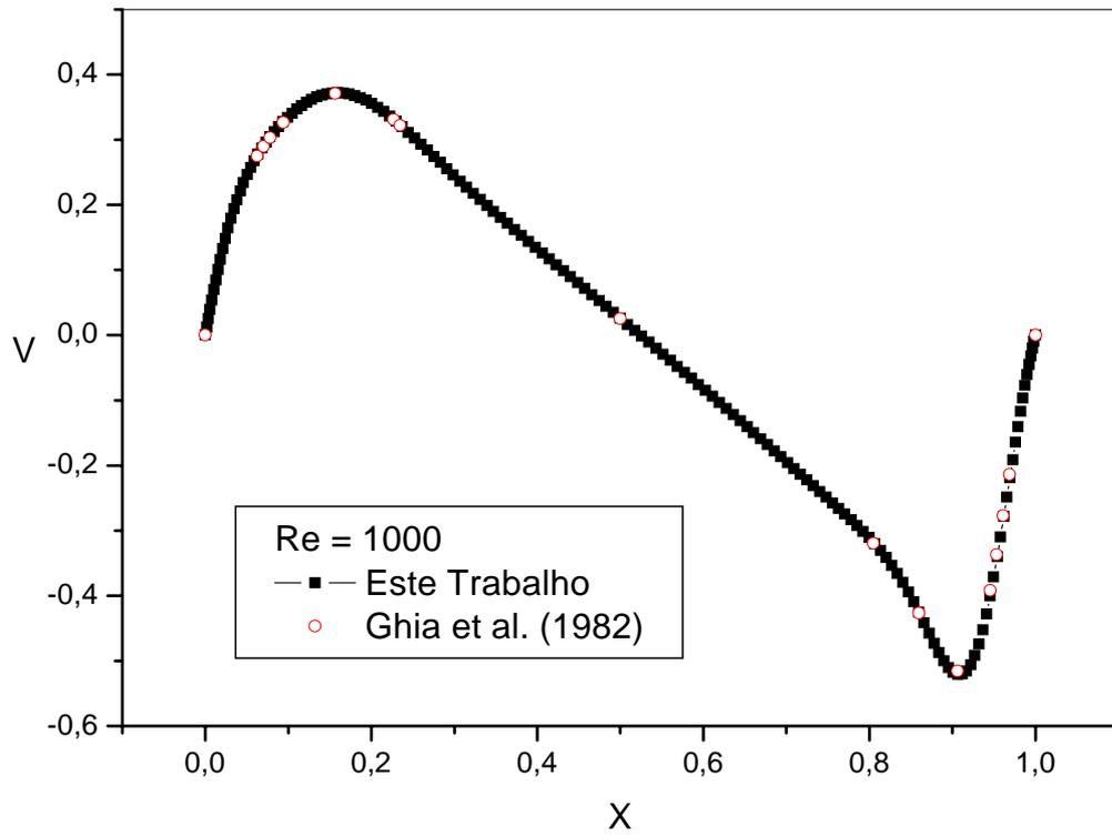
Figura 7.6 - Componente de velocidade  $V$  para  $Y = 0,5$  e  $Re = 1000$ .
