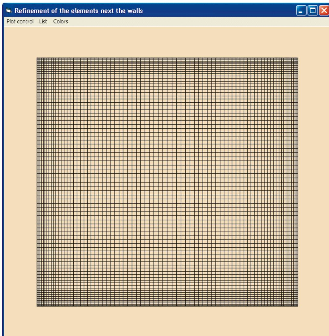
Figura 7.2 - Malha de 6400 elementos de nove nós e 25921 pontos nodais.
