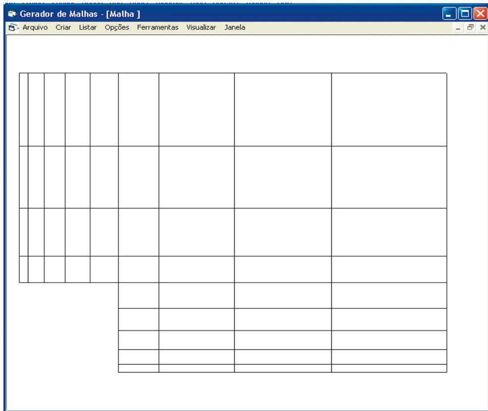
Figura 6.11 - Malha no formato degrau com elementos retangulares sobre domínio duplamente conexo.
