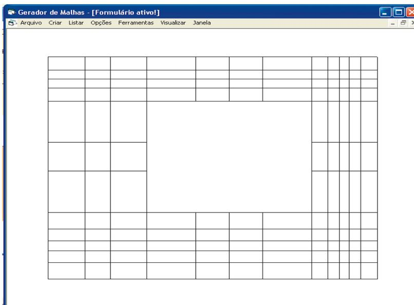
Figura A.50 - Malha com um furo, constituída de elementos retangulares.
