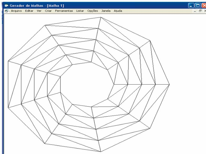
Figura A.69 - Malha na forma de setor de coroa, com elementos triangulares.
