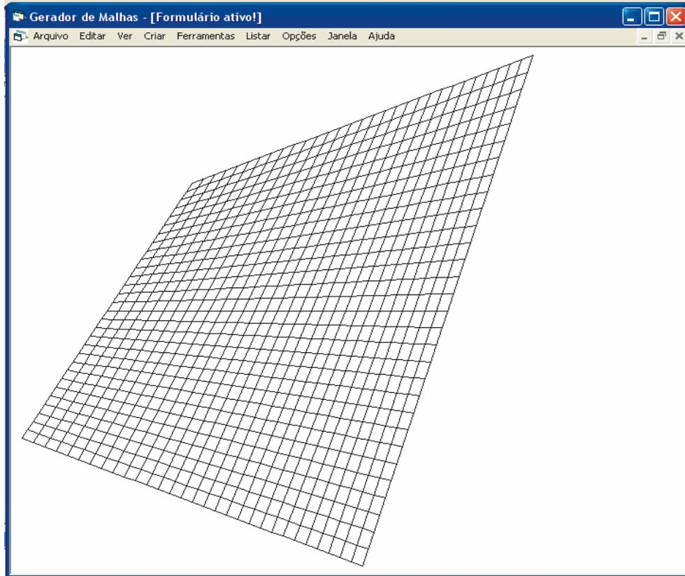
Figura 6.13 - Malha quadrilateral com elementos retangulares.
