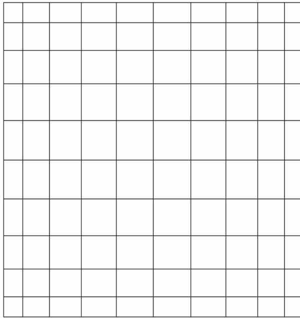
Figura 3.22 - Refino dos elementos retangulares nas laterais,  $c = 0.5$ .
