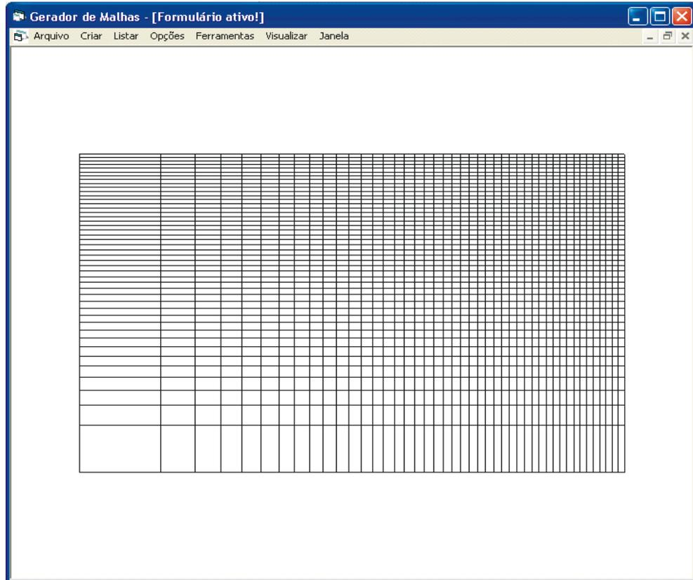
Figura 6.9 - Malha refinada de baixo para cima e da esquerda para direita, com elementos retangulares.
