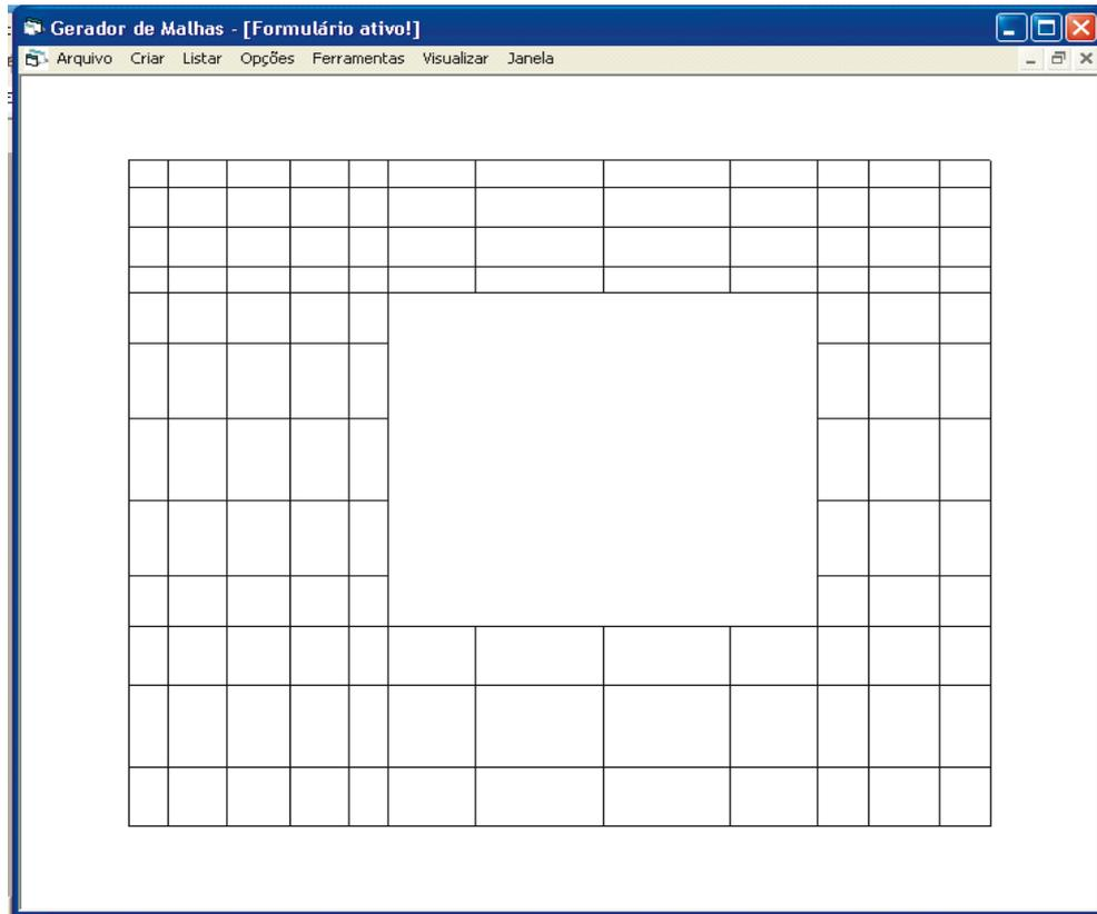
Figura 6.10 - Malha de elementos retangulares sobre domínio duplamente conexo.
