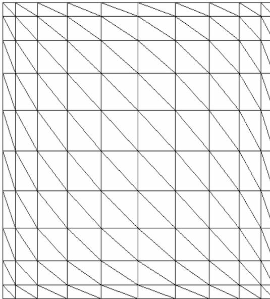
Figura 3.21 - Refino dos elementos triangulares nas laterais,  $c = 0.25$ .
