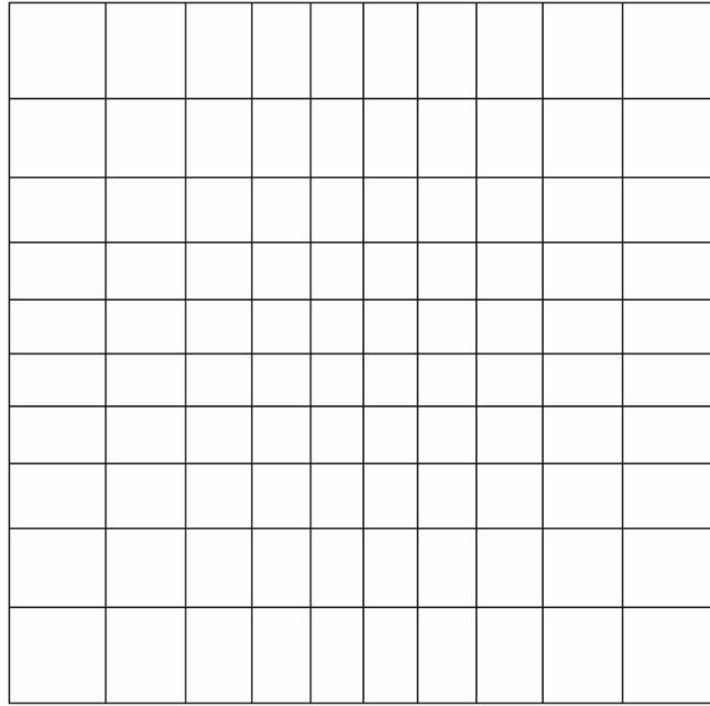
Figura 3.14 - Refino de elementos retangulares no centro,  $c = 2$ .
