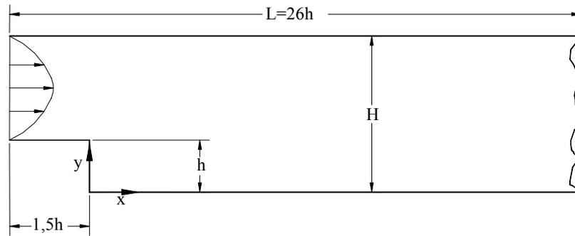
Figura 7.16 - Dimensões e geometria do canal com degrau
