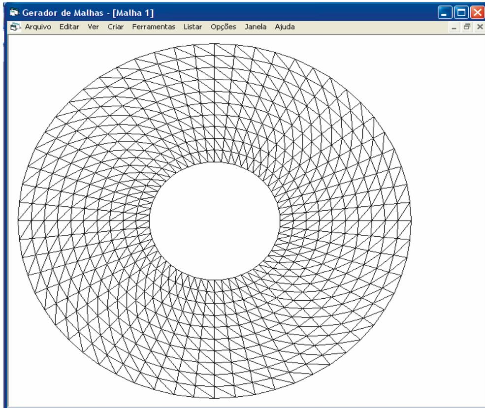
Figura 6.16 - Malha em forma de coroa com elementos triangulares.
