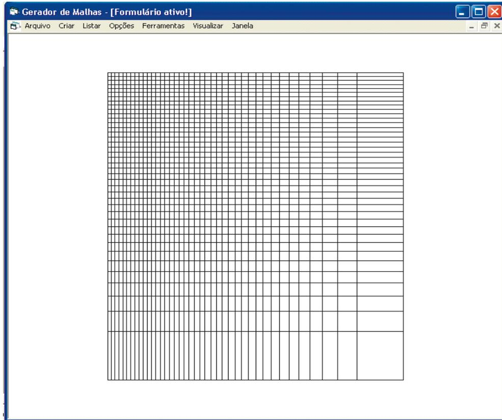
Figura 6.8 - Malha refinada de baixo para cima e da direita para esquerda, com elementos retangulares.
