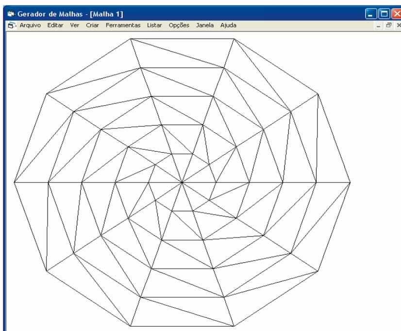
Figura A.65 - Malha na forma de círculo, com elementos triangulares.
