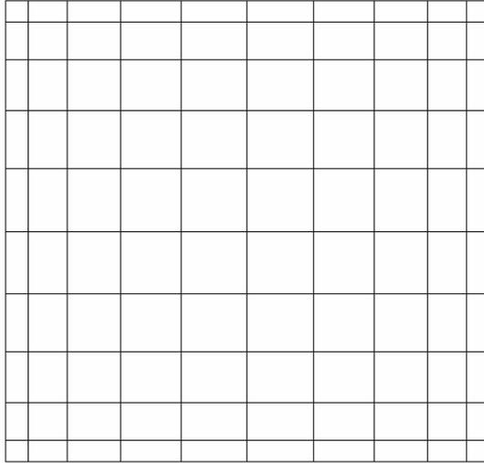
Figura 3.20 - Refino dos elementos retangulares nas laterais,  $c = 0.25$ .
