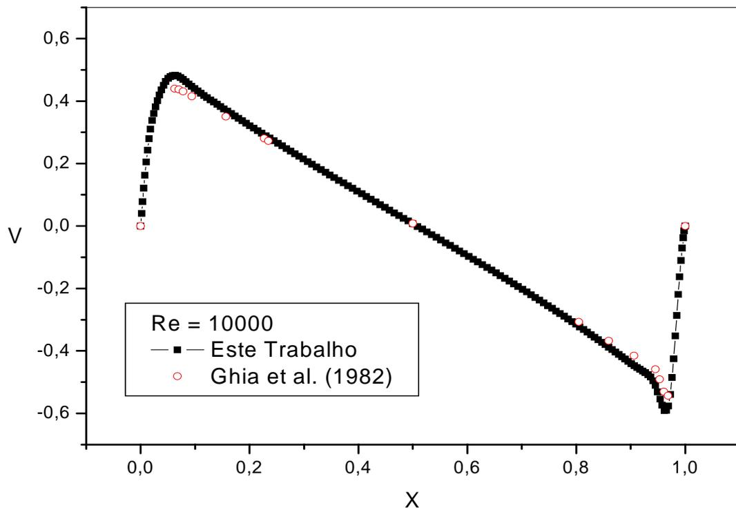
Figura 7.14 - Componente de velocidade V para  $Y = 0,5$  e  $Re = 10000$ .
