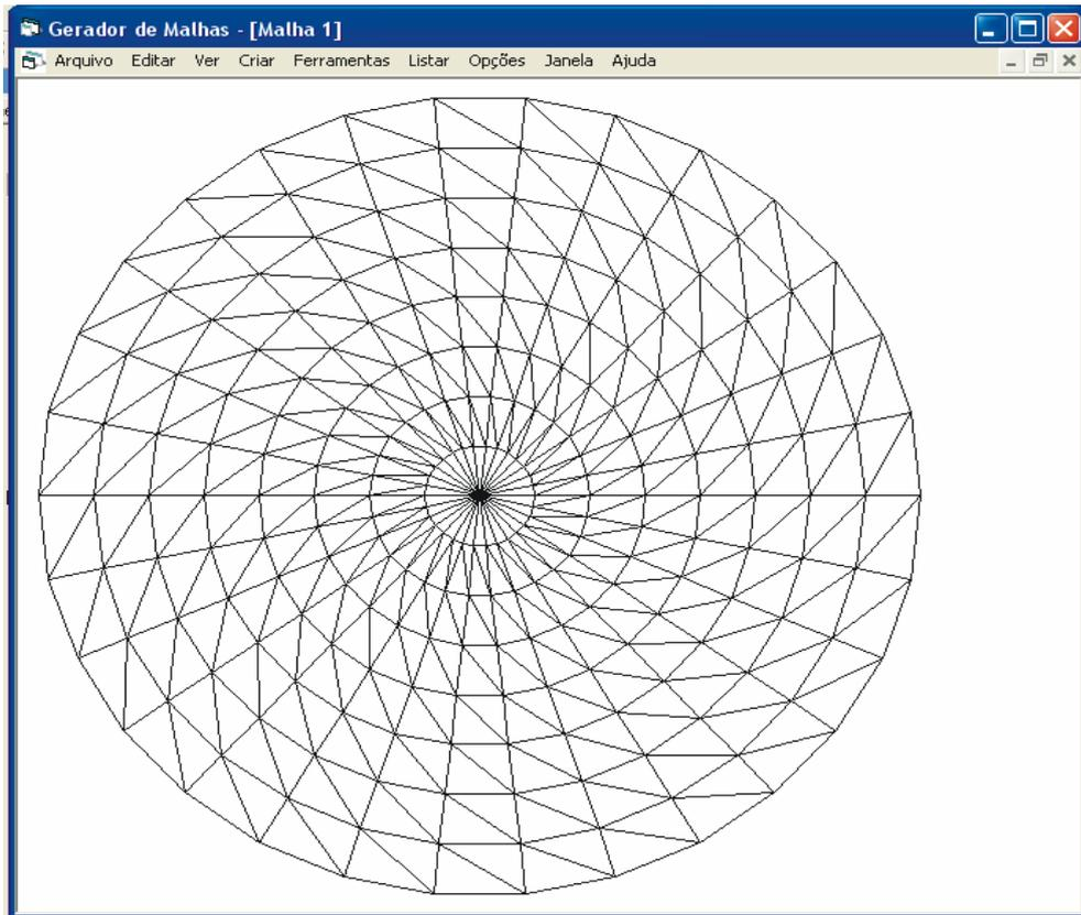
Figura 6.15 - Malha circular com elementos triangulares.
