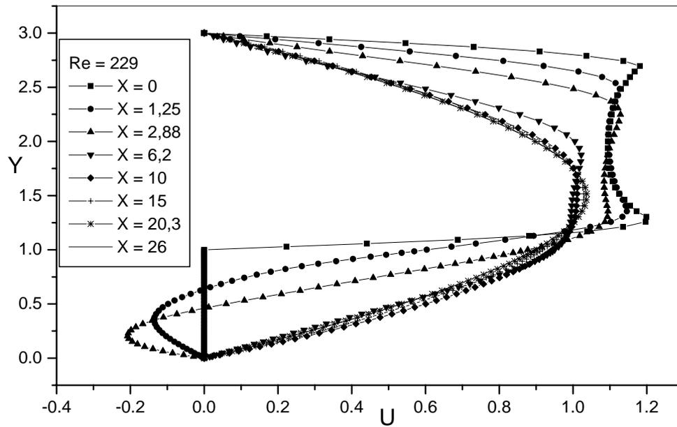
Figura 7.18 - Velocidade axial em várias posições ao longo do canal,  $Re = 229$
