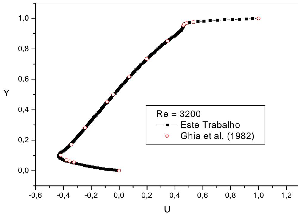
Figura 7.7 - Componente de velocidade  $U$  para  $X = 0,5$  e  $Re = 3200$ .
