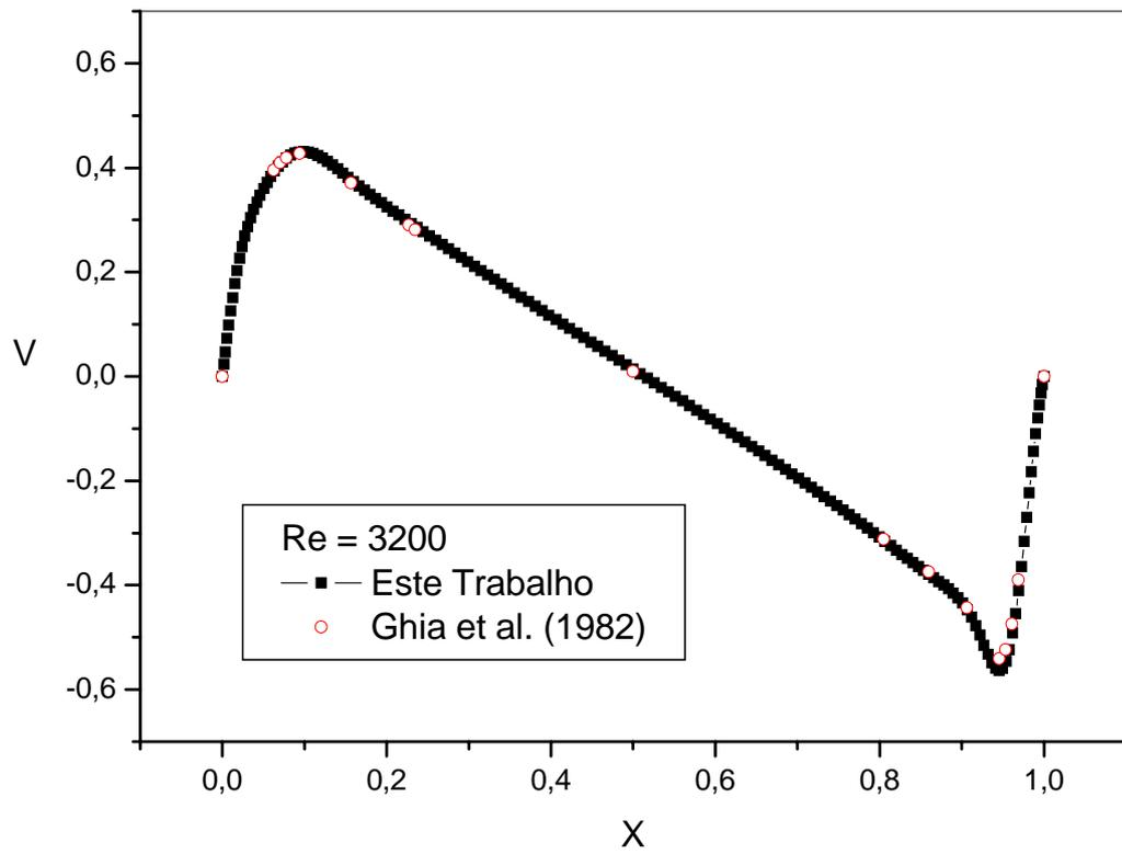
Figura 7.8 - Componente de velocidade V para  $Y = 0,5$  e  $Re = 3200$ .
