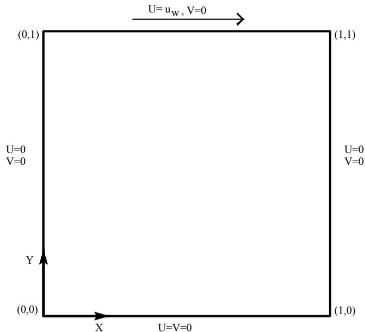
Figura 7.1 - Geometria e condições de contorno da cavidade quadrada.
