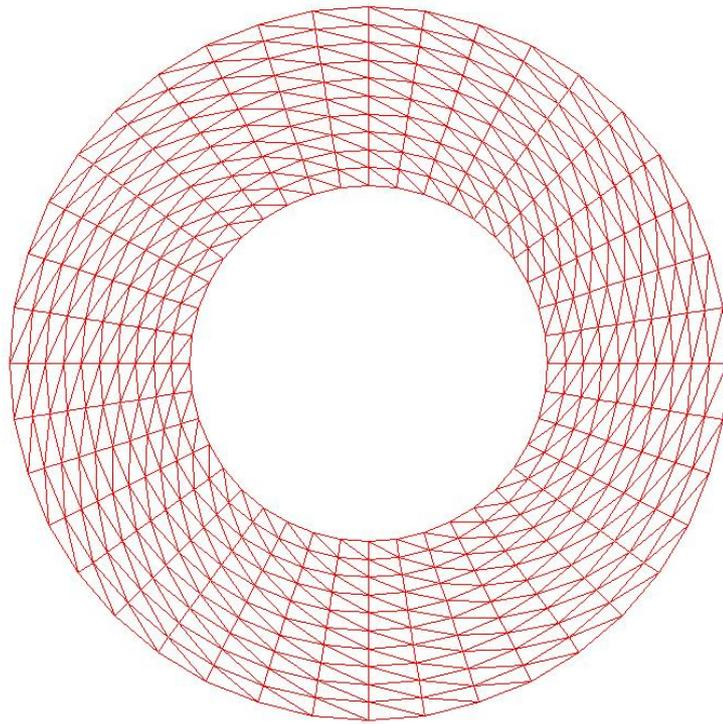
Figura 4.5 - Coroa circular subdividida em elementos triangulares.
