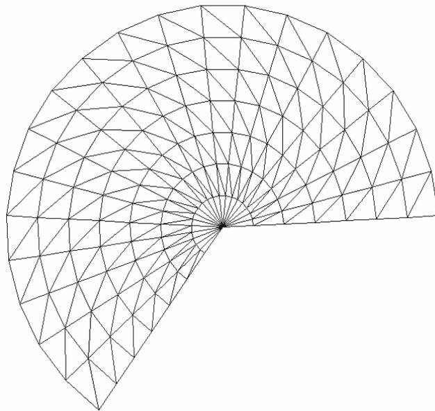
Figura 4.6 - Semicírculo subdividido em elementos triangulares.
