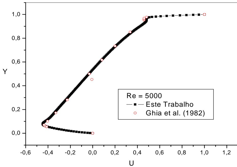
Figura 7.9 - Componente de velocidade U para  $X = 0,5$  e  $Re = 5000$ .
