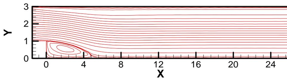
Figura 7.19 - Funções de corrente num canal com expansão em degrau, para  $Re = 229$ .
