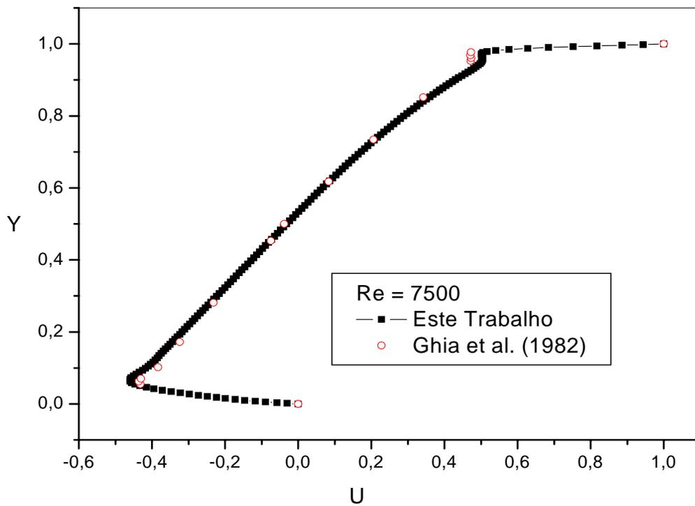
Figura 7.11 - Componente de velocidade U para  $X = 0,5$  e  $Re = 7500$ .
