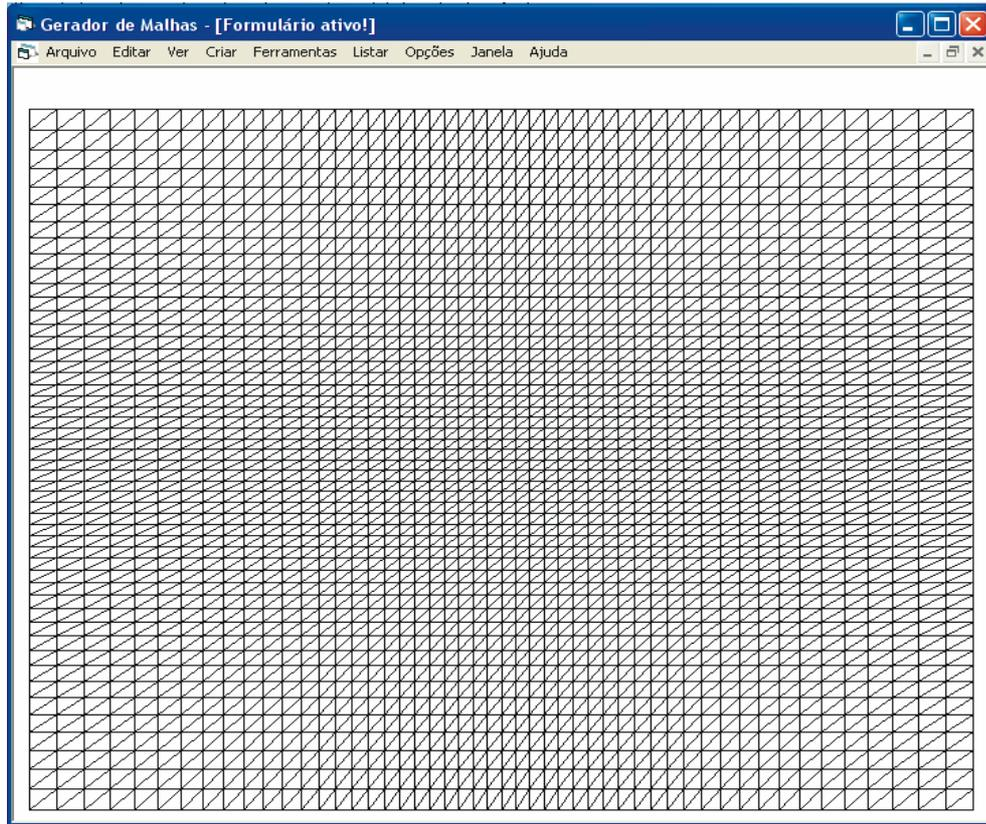
Figura 6.7 - Malha com elementos triangulares, refinada no centro.
