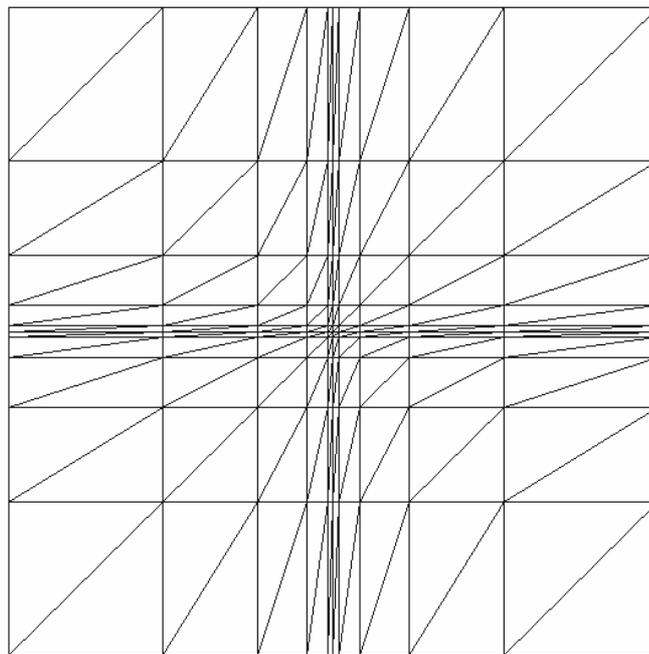
Figura 3.19 - Refino de elementos triangulares no centro,  $c = 2.9$ .
