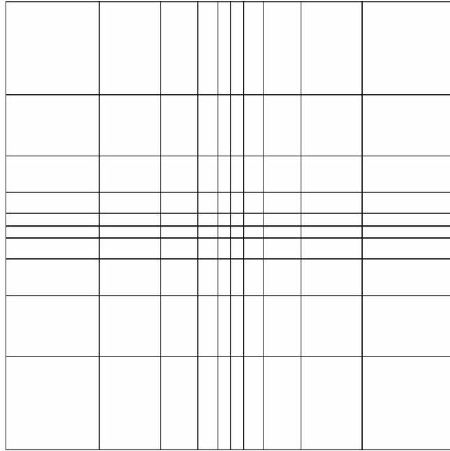
Figura 3.16 Refino de elementos retangulares no centro,  $c = 2.5$ .
