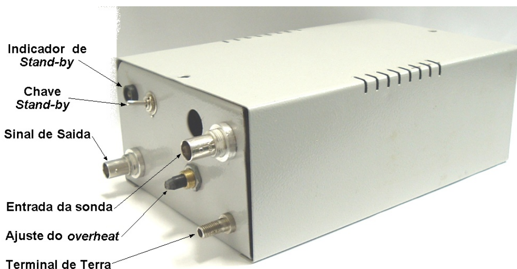
FIGURA 3.4 – Primeiro protótipo do anemômetro de fio quente – vista frontal.
