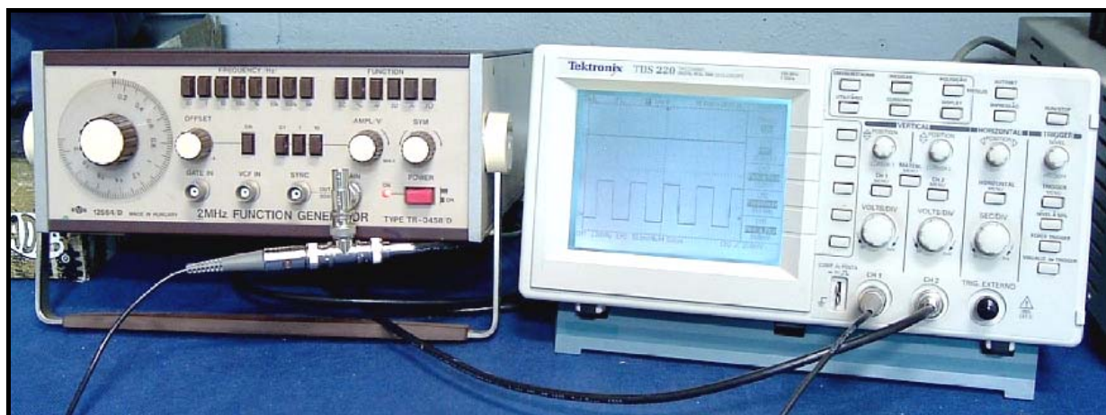
FIGURA 4.20 – Detalhe do gerador de funções e do osciloscópio utilizados no teste com gerador de sinais no circuito da ponte de Wheatstone do segundo protótipo.
