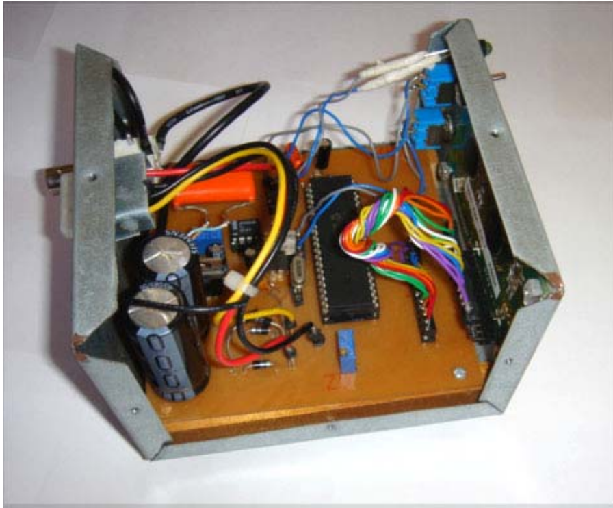
Figura 3.12 - Foto do interior da caixa metálica.
