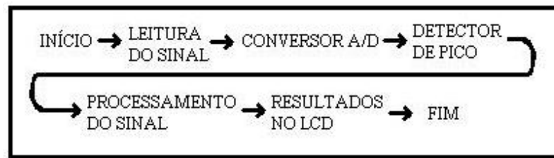
Figura 3.10 - Seqüência lógica das operações realizadas pelo microcontrolador.
