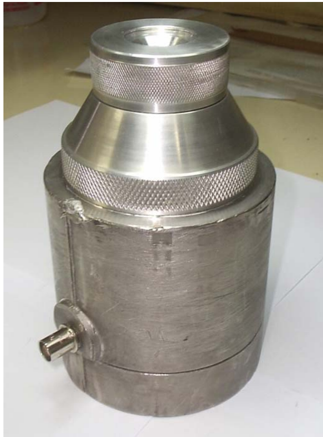
Figura 3.7 - Câmara piroelétrica blindada com alloy , vista externa.
