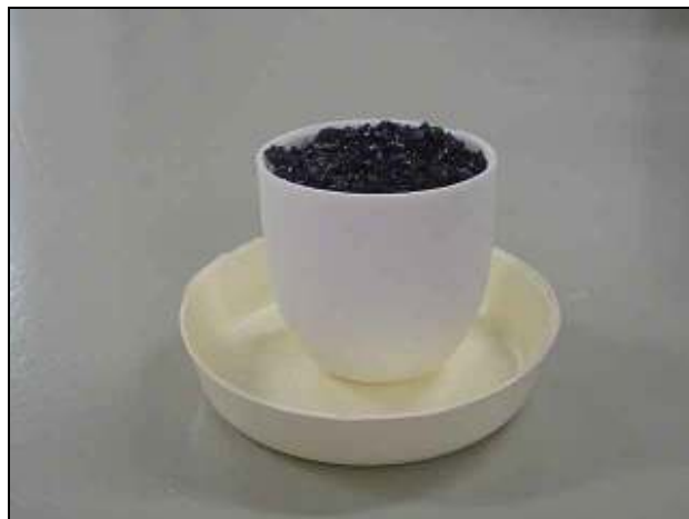
Figura 13 - Cadinho de alumina contendo a mistura de pós a ser fundida.
