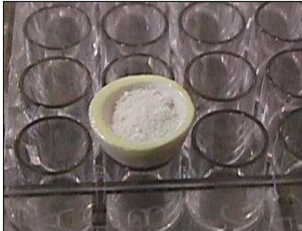
Figura 24 - Metade de uma cápsula de Anortita preenchida com Prolopa ® HBS.
