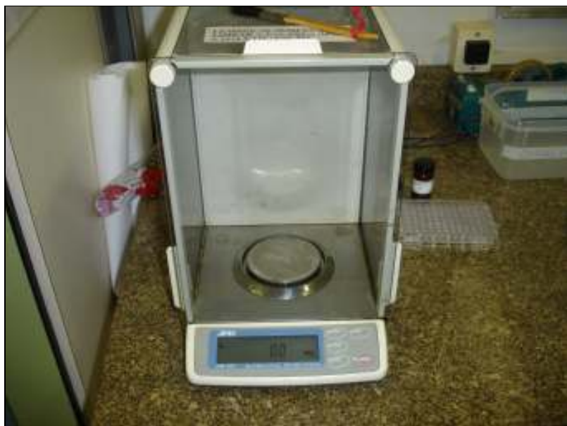
Figura 23 - Balança analítica utilizada na avaliação das massas das cápsulas.
