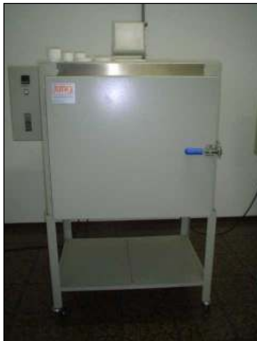
Figura 21 - Forno Jung® utilizado para a cristalização das cápsulas.
