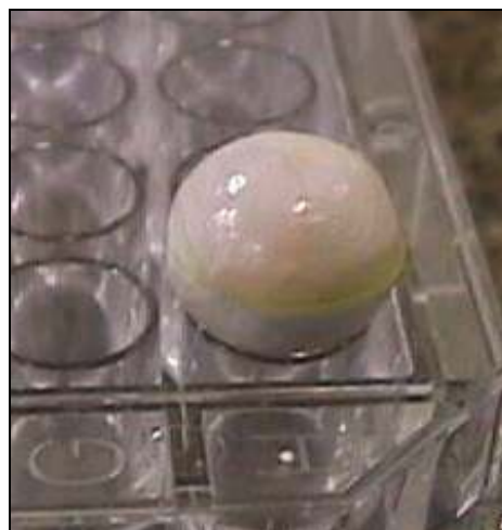
Figura 26 - Cápsula de Anortita vedada com silicone incolor.
