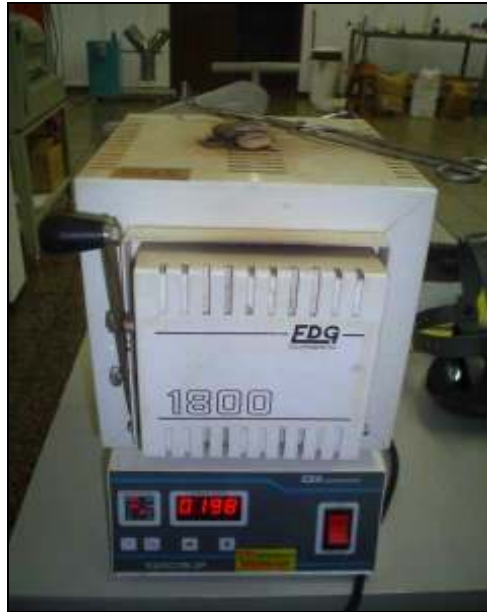
Figura 18 - Forno EDG® 1800 utilizado para recozimento.
