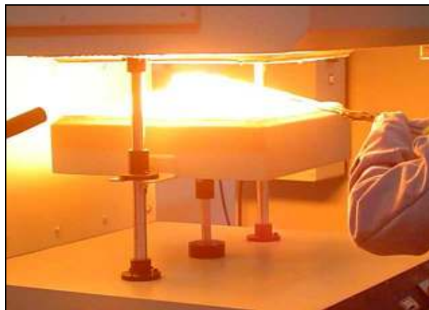
Figura 16 - Abertura do forno e retirada dos cadinhos com o material fundido para vazamento no molde.
