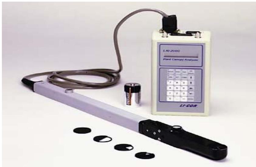
Figura 5 – Medidor do índice de área foliar, LAI – 2000. Fonte: LI-COR Environment
