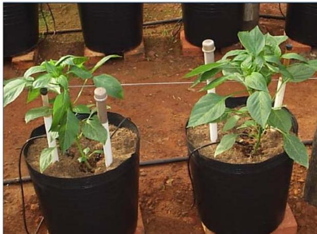
Figura 9 – Vasos com tensiômetros e extratores de cápsula porosa
