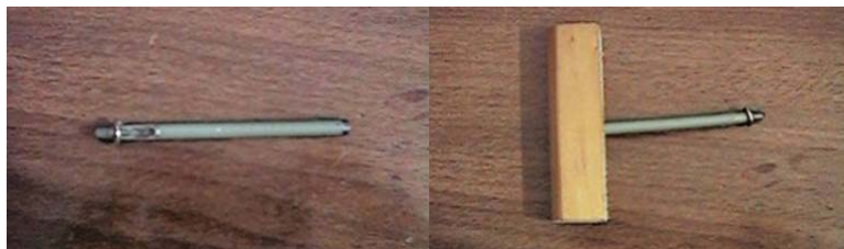
Figura 30 - Vazadores utilizados para instalação do microtubo
