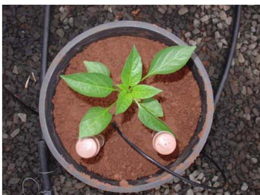
Figura 3A – Vista superior de vaso com tensiômetro
