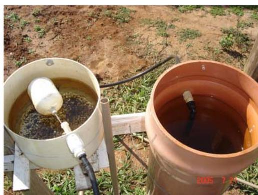
Figura 6A – Vista superior da caixa de entrada e do filtro lento
