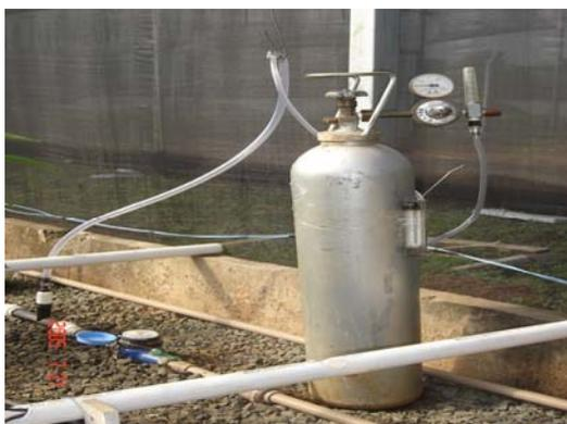
Figura 7A – Sistema de injeção de CO<sub>2</sub>
