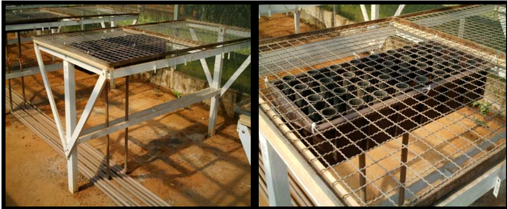
Figura 3 - bancadas em madeira e tela metálica
