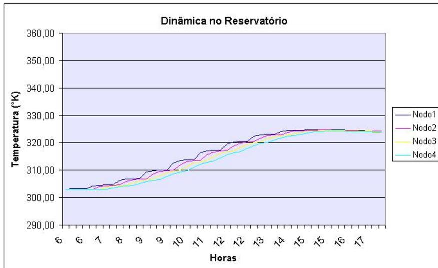
Figura 4.7: Evolução da temperatura do fluido no reservatório.
