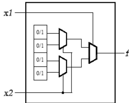
*Figura 2.5 - Circuito para um LUT com duas entradas.*
