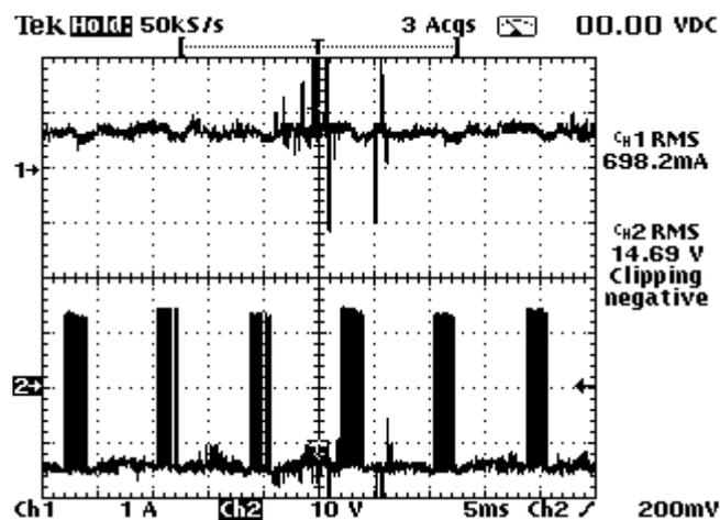
Figura 6.39 – Etapa 3 (Potência Constante): Corrente indutor (superior) e Tensão “gate” Chave Boost (inferior) do reator para uma lâmpada à vapor de sódio de 70W. (1A/div;10V/div; 5ms/div)
