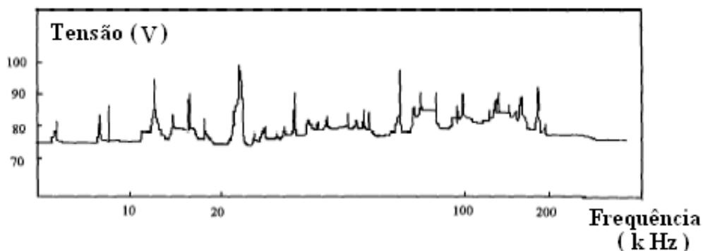
**Figura 1.15 – Ressonância acústica em uma lâmpada de vapor metálico de 70W (variação da tensão eficaz sobre a lâmpada).**
