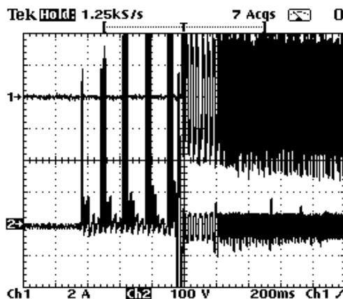
*Figura 6.21-Etapa ignição: Corrente (superior) e Tensão (inferior) de uma lâmpada à vapores metálicos de 250W após uma ignição bem sucedida. ( 100V/div; 2A/div; 200ms/div).*
