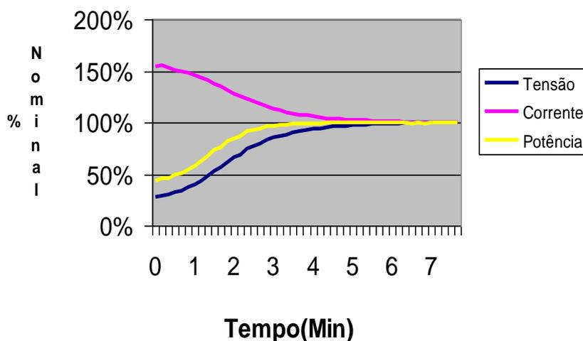
Figura 6.25– Comportamento da tensão, corrente e potência de uma lâmpada à vapor de sódio de 250W, acionada por reator eletromagnético.
