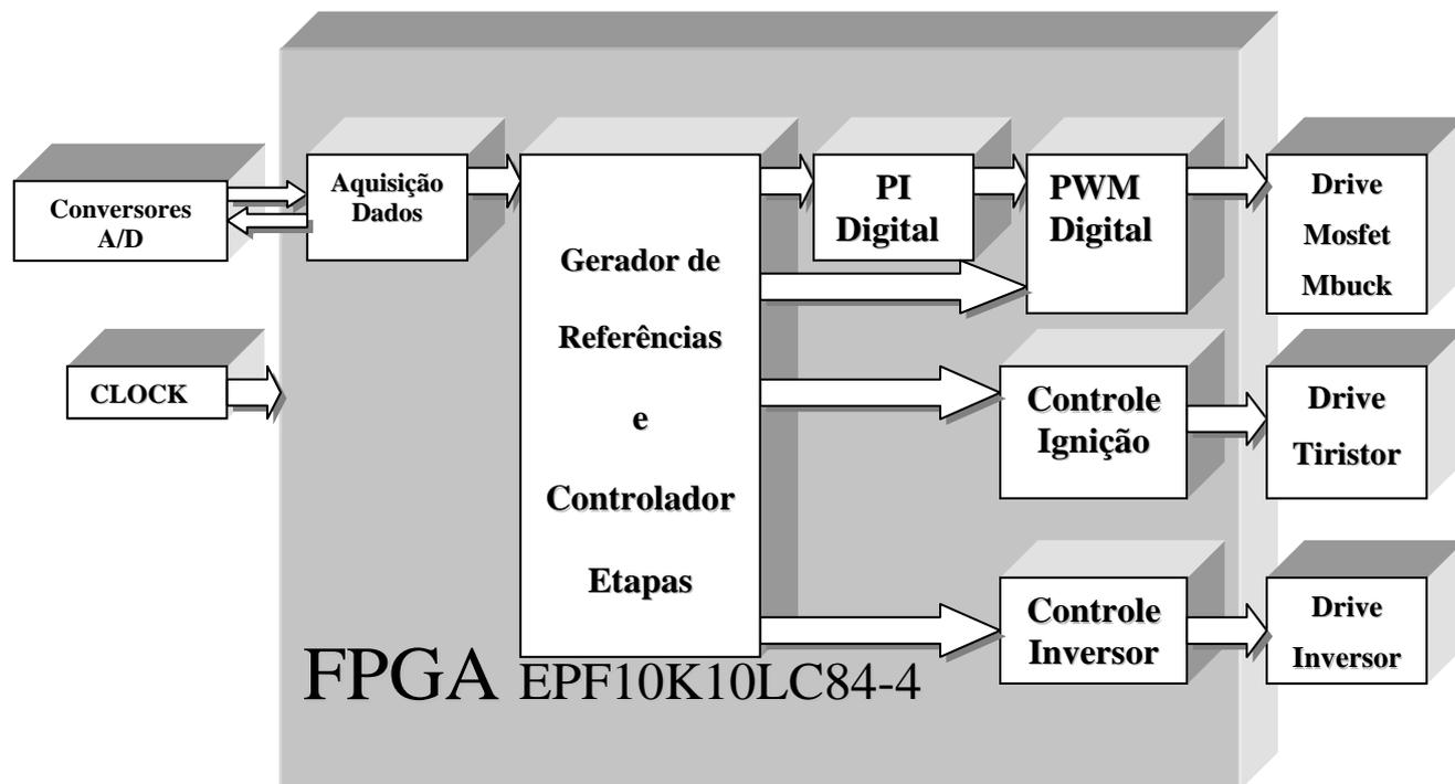
*Figura 5.2- Diagrama de blocos do dispositivo FPGA.*
