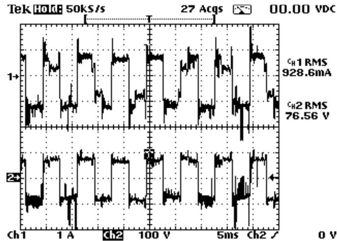
Figura 6.40-Etapa 3 (Potência Constante):Corrente (superior) e Tensão (inferior) de uma lâmpada à vapor de sódio de 70W. (1A/div;100V/div;5ms/div).
