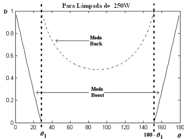
**Figura 4.7 –Variação da Razão Cíclica do conversor Buck+Boost em Cascata em Função da Tensão de Entrada Retificada para a Lâmpada de 250W.**
