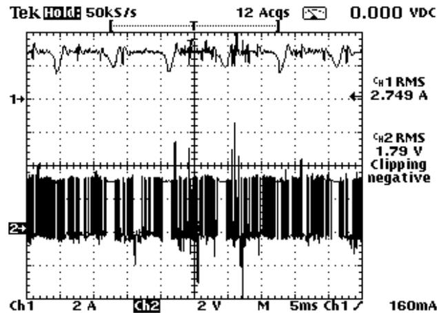
Figura 6.68 — Etapa2 (Corrente Constante): Corrente indutor (superior) e Tensão dos pulsos disparo Chave Buck (inferior) do reator para uma lâmpada a vapores metálicos 250W. (2A/div;1V/div; 5ms/div).
