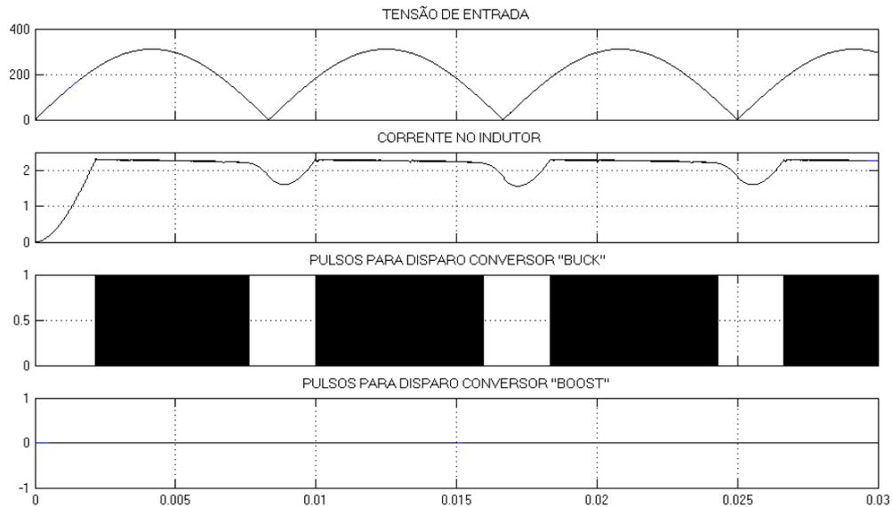
**Figura 6.48-Simulação da Etapa de Aquecimento para Lâmpada de 150W. Forma de Onda de Tensão de entrada, Corrente no Indutor e Pulsos para disparo da chava  $M_{Buck}$  (100V/div; 0,5A/div; 0,5V/div; 5ms/div)**
