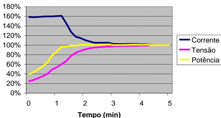
*Figura 6.10 – Comportamento da tensão, corrente e potência de uma lâmpada à vapor de sódio de 70W, acionada por reator eletrônico.*
