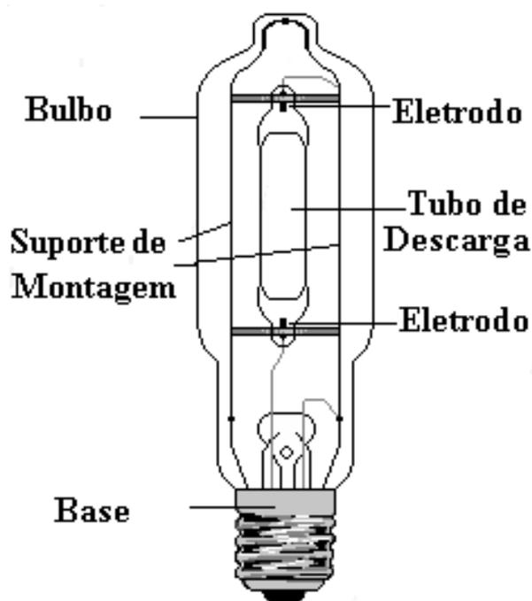
*Figura .1.7 –Lâmpada Vapor Metálico de Alta Pressão*
