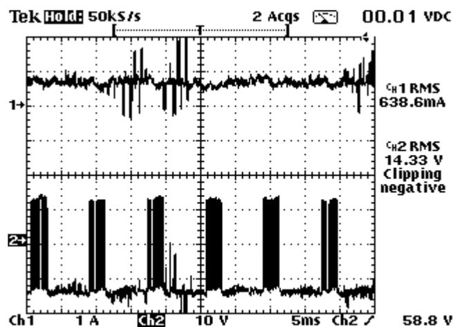
Figura 6.40 – Etapa3 (Potência Constante): Corrente indutor (superior) e Tensão “gate” Chave Boost (inferior) do reator para uma lâmpada à vapores metálicos de 70W. (1A/div;10V/div; 5ms/div)
