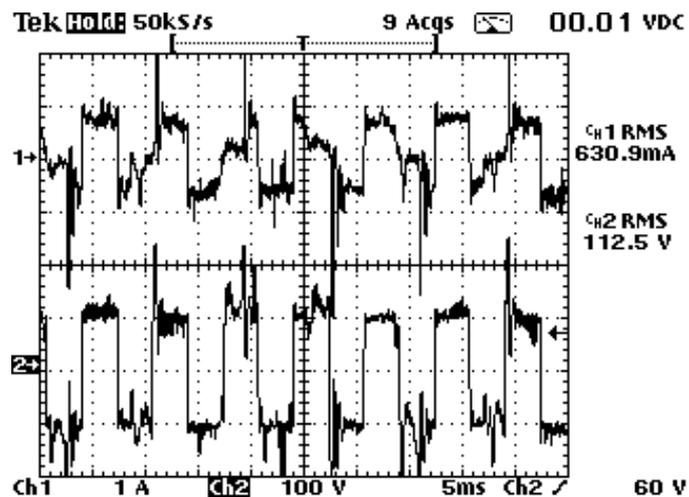
Figura 6.41 – Etapa 3 (Potência Constante): Corrente (superior) e Tensão (inferior) de uma lâmpada à vapores metálicos de 70W (1A/div;100V/div;5ms/div).
