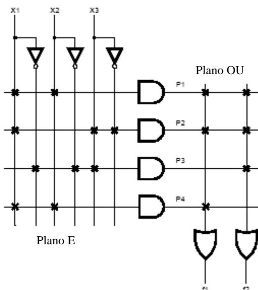
**Figura - 2.1 - Esquema simplificado de um PLA.**
