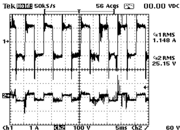
Figura 6.31 – Etapa 2 (Corrente Constante): Corrente (superior) e Tensão (inferior) de uma lâmpada à vapores metálicos de 70W. (1A/div;50V/div; 2ms/div).
