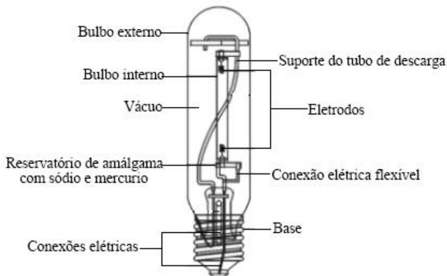
**Figura .1.6 –Lâmpada Vapor de Sódio de Alta Pressão**
