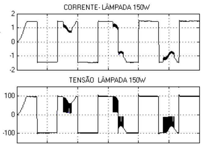
*Figura 6.56-Simulação da Etapa de Regime Permanente para Lâmpada de 150W. Forma de Onda de Corrente e Tensão Respectivamente ( 1A/div; 100V/div 5ms/div)*
