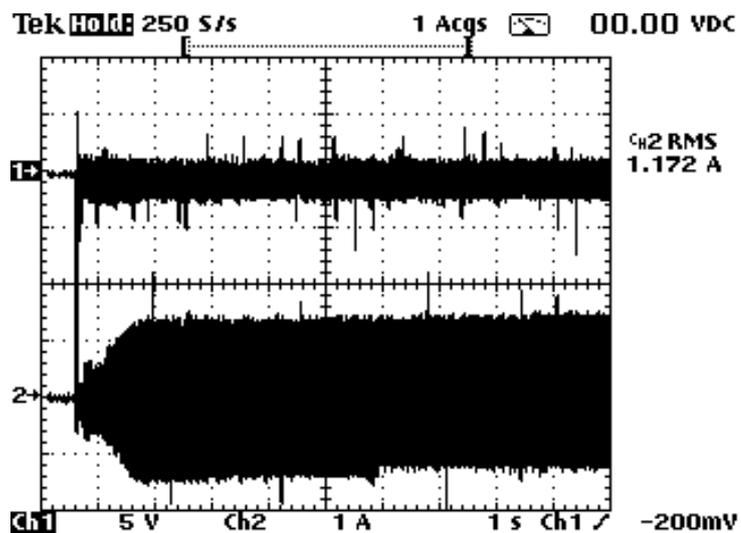
*Figura 6.3-Etapa ignição: Tensão (superior) e Corrente (inferior) de uma lâmpada à vapores metálicos de 70W após uma ignição bem sucedida. ( 50V/div; 1A/div; 100ms/div).*
