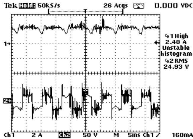
*Figura 6.50 – Etapa 2 (Corrente Constante): Corrente indutor (superior) e Tensão na lâmpada (inferior) do reator para uma lâmpada à vapores metálicos 150W. (1A/div; 5ms/div)*
