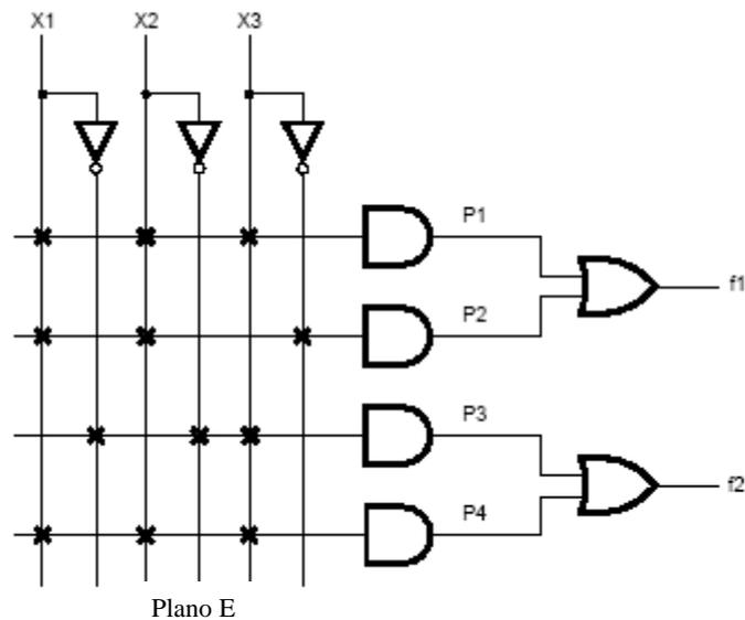
**Figura 2.2 - Esquema simplificado de um PAL.**
