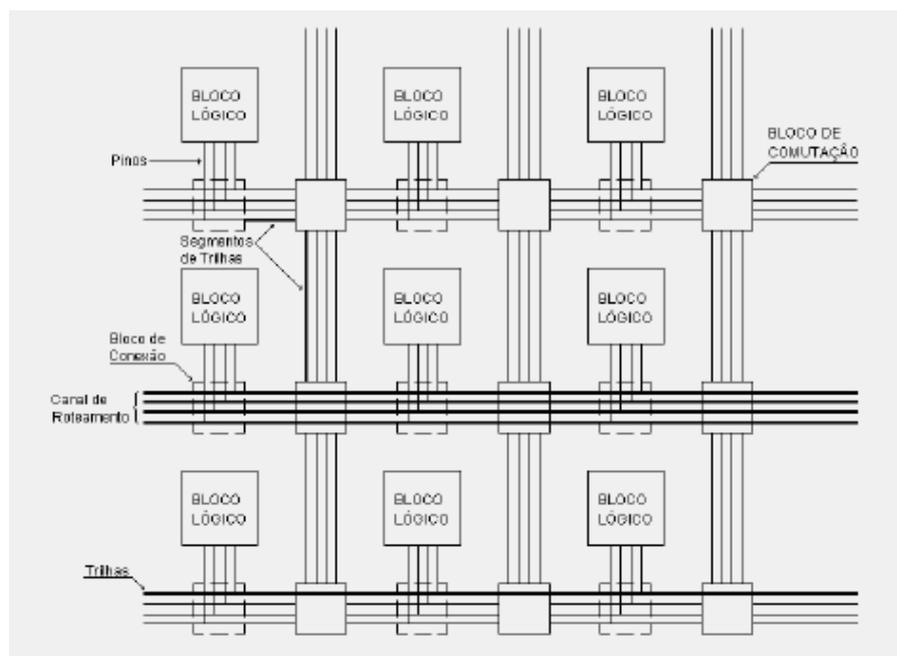
**Figura 2.8 - Arquitetura Geral de Roteamento de um FPGA.**
