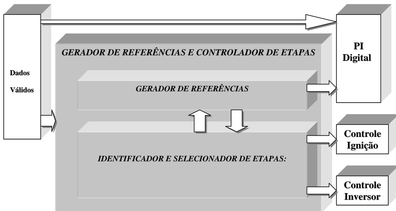
**Figura5.4- Bloco Gerador de Referências e Controlador de Etapas.**
