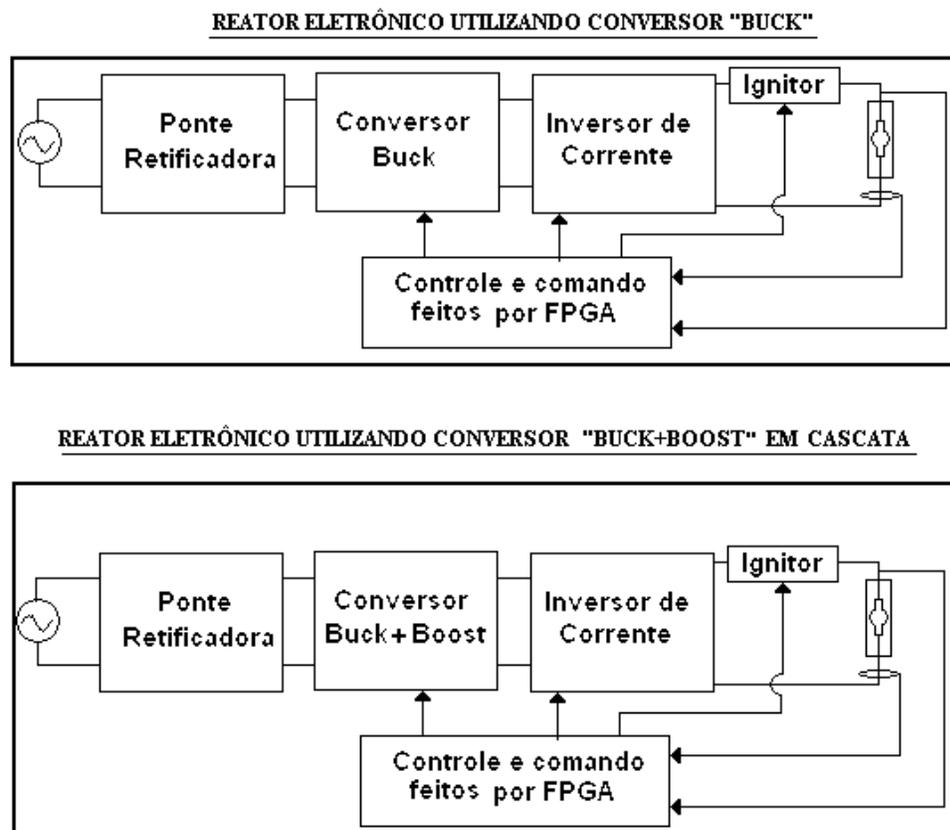
Fig. 1.1 – Diagrama de blocos dos reatores eletrônicos propostos
