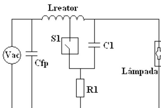
**Figura 1.10 – Diagrama de reator eletromagnético típico.**
