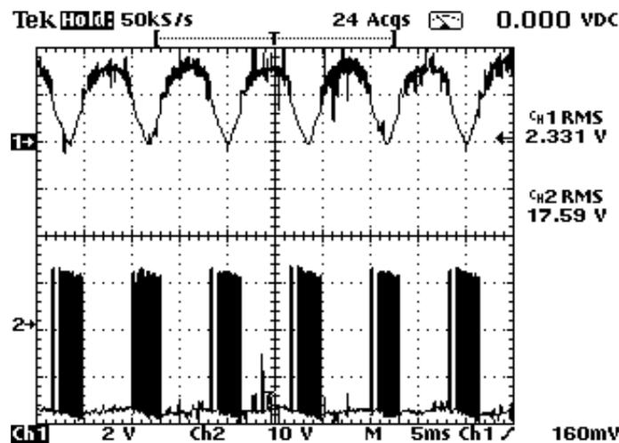
Figura 6.72 – Etapa 3 (Potência Constante): Corrente indutor (superior) e Tensão Disparo Chave” Boost” (inferior) do reator para uma lâmpada à vapor de sódio de 250W. (2A/div;10V/div; 5ms/div)
