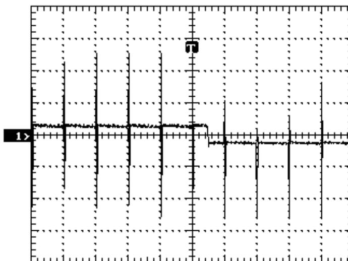
*Figura 6.1-Pulsos de sobretensão gerados pelo reator eletrônico(1000V/div,2ms/div).*
