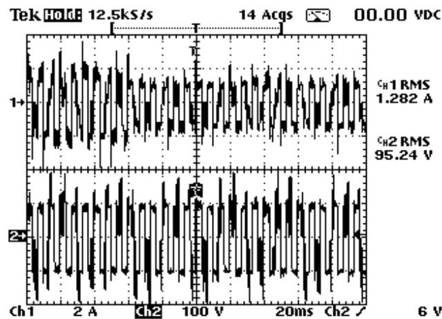
Figura 6.60-Etapa 3 (Potência Constante-Dimerização):Corrente (superior) e Tensão (inferior) de uma lâmpada à vapor de sódio de 150W. (2A/div;100V/div;5ms/div).
