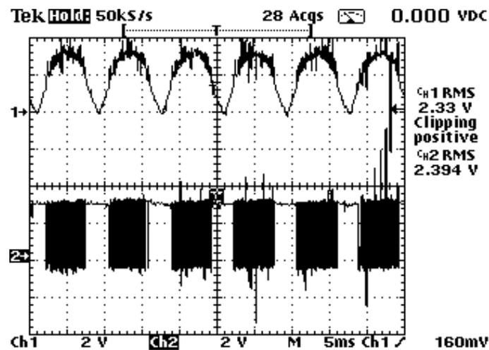
Figura 6.73 – Etapa 3 (Potência Constante): Corrente indutor (superior) e Tensão Disparo Chave Boost (inferior) do reator para uma lâmpada à vapores metálicos de 250W. (2A/div;10V/div; 5ms/div)
