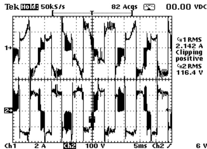
*Figura 6.76 – Etapa3 (Potência Constante): Corrente (superior) e Tensão (inferior) de uma lâmpada à vapores metálicos de 250W (2A/div;100V/div;5ms/div)*
