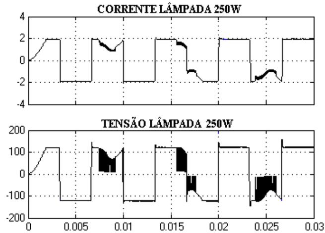
*Figura 6.74-Simulação da Etapa de Regime Permanente para Lâmpada de 250W. Forma de Onda de Corrente e Tensão Respectivamente ( 2A/div; 100V/div 5ms/div)*
