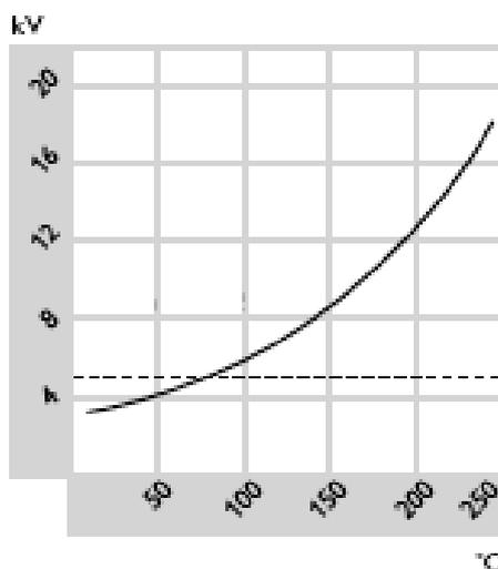
*Figura 1.9 – Tensão de ignição em função da temperatura em uma lâmpada vapor de mercúrio. ( fonte: Application guide to HID lamp control gear – (WWW.LIGHTING.PHILIPS.COM/INDEX.HTM..)).*
