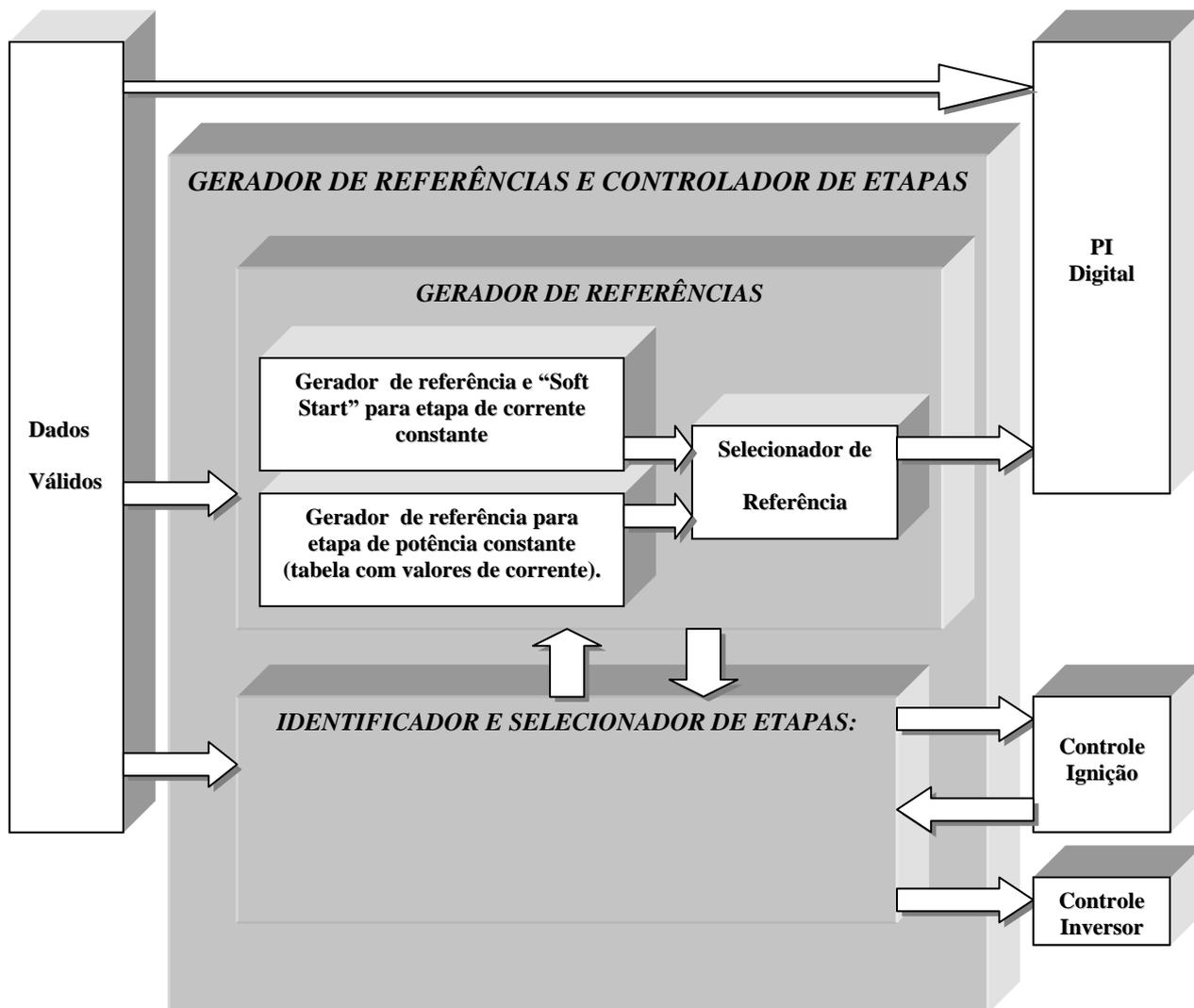
*Figura 5.6- Detalhes do bloco Gerador de Referências.*
