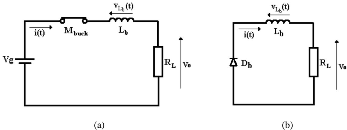
Fig. 3.2– Circuito equivalente para cada uma das duas etapas de operação do conversor *Buck*.
