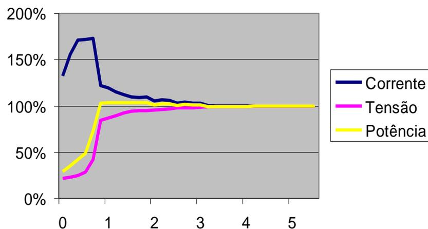
*Figura 6.12 – Comportamento da tensão, corrente e potência de uma lâmpada à vapor metálica de 70W, acionada por reator eletrônico.*
