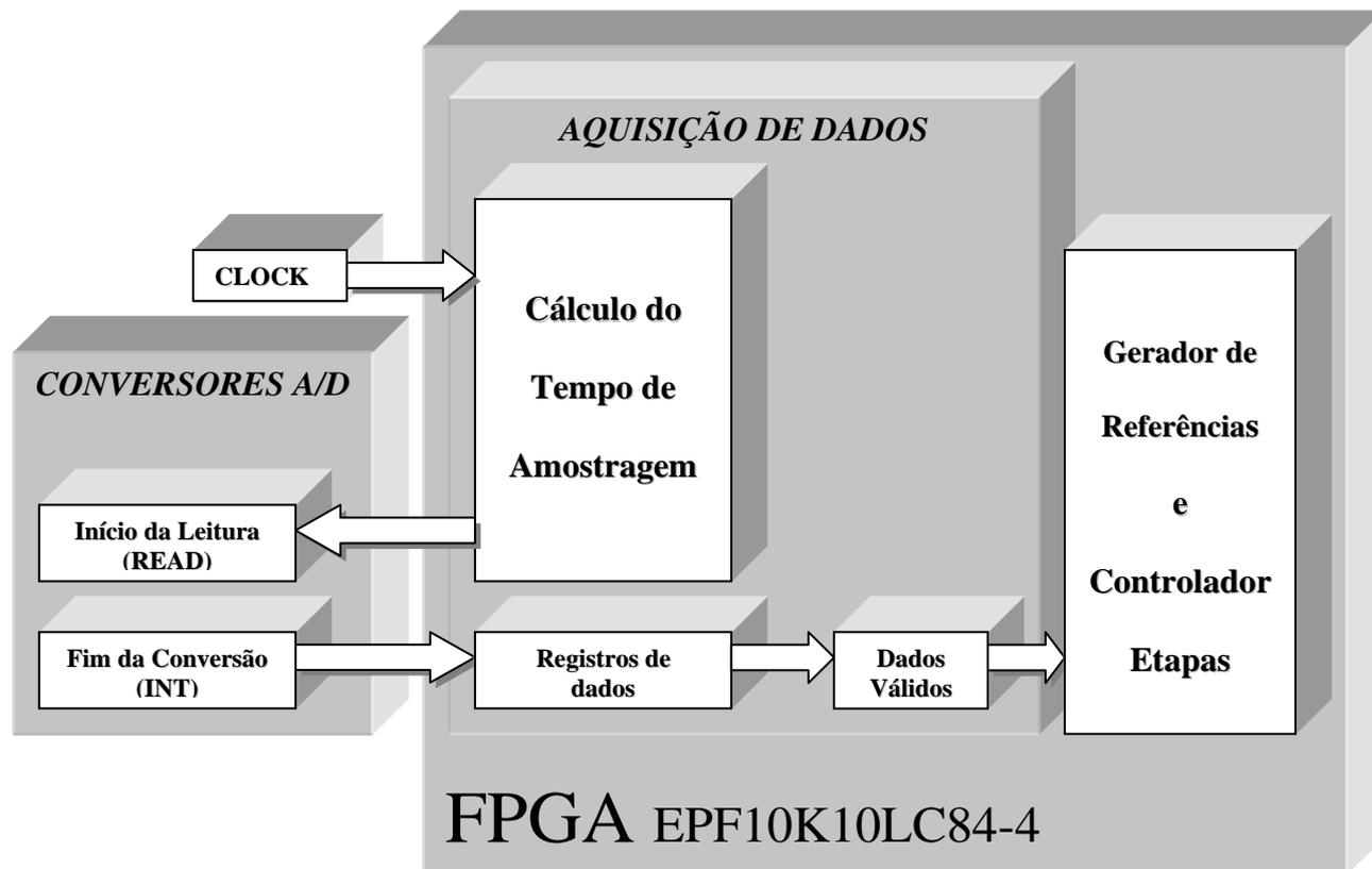
*Figura5.3- Bloco de Aquisição de dados.*
