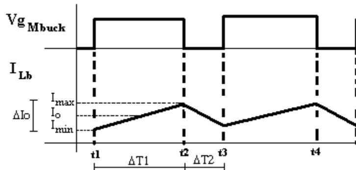
Fig. 3.3 – Formas de onda no circuito *Buck*.
