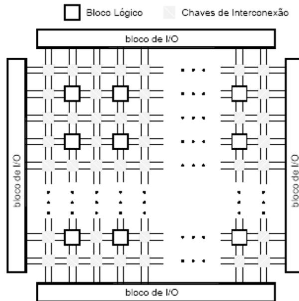
**Figura 2.4 – Estrutura básica de um FPGA.**
