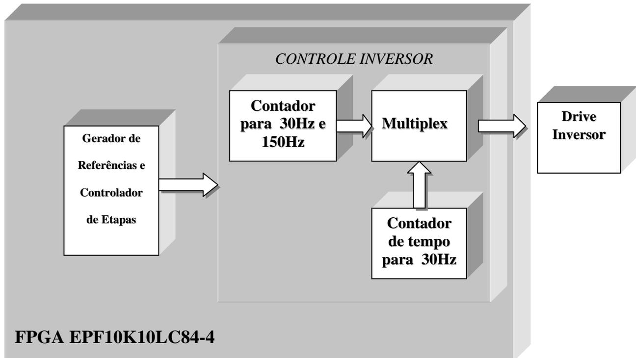
*Figura 5.10- Detalhes do bloco “Controle do Inversor”.*
