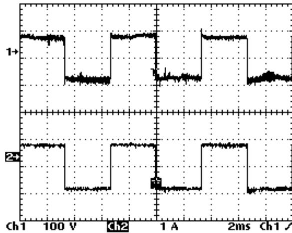
*Figura 6.8 – Etapa 3 (Potência Constante): Tensão (superior) e Corrente(inferior) de uma lâmpada à vapor de sódio de 70W( 100V/div; 1A/div; 500ms/div*
