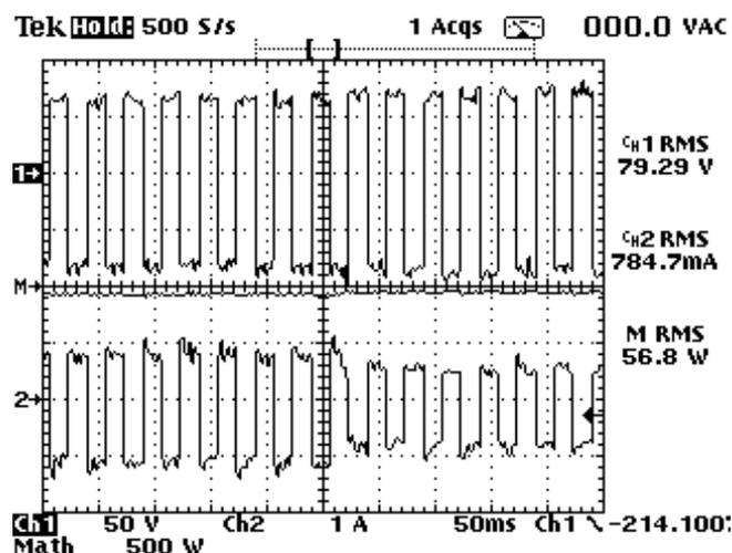
**Figura 6.5 –Resultado Experimental, Dimerização: Tensão (superior) e Corrente (inferior) de uma lâmpada à vapor de sódio 70W. 50V/div; 1A/div; 50ms/div).**
