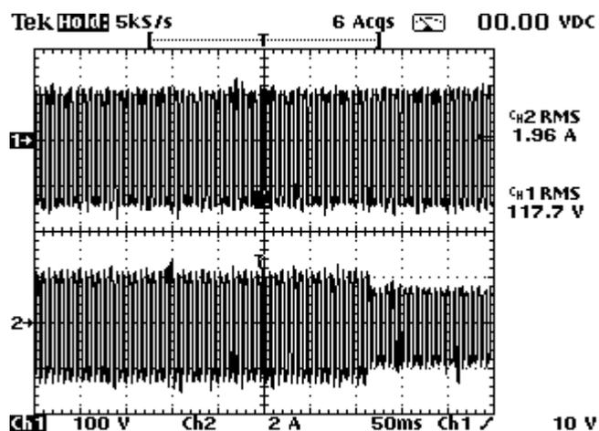
*Figura 6.23 –Resultado Experimental, Dimerização: Tensão (superior) e Corrente (inferior) de uma lâmpada à vapor de sódio 250W. 100V/div; 2A/div; 50ms/div).*
