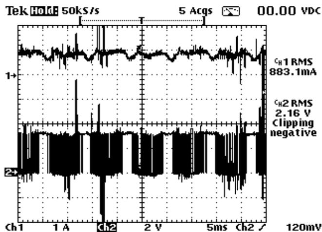
Figura 6.32 – Etapa2 (Corrente Constante): Corrente indutor (superior) e Tensão “gate” Chave Buck (inferior) do reator para uma lâmpada à vapor de sódio de 70W. (1A/div; 2V/div; 5ms/div).
