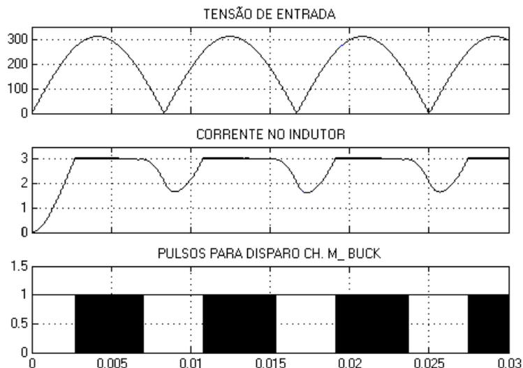
**Figura 6.66** Simulação da Etapa de Aquecimento para Lâmpada de 250W. Forma de Onda de Tensão de entrada, Corrente no Indutor e Pulsos para disparo da chava  $M_{Buck}$  (100V/div; 0,5A/div; 0,5V/div; 5ms/div).
