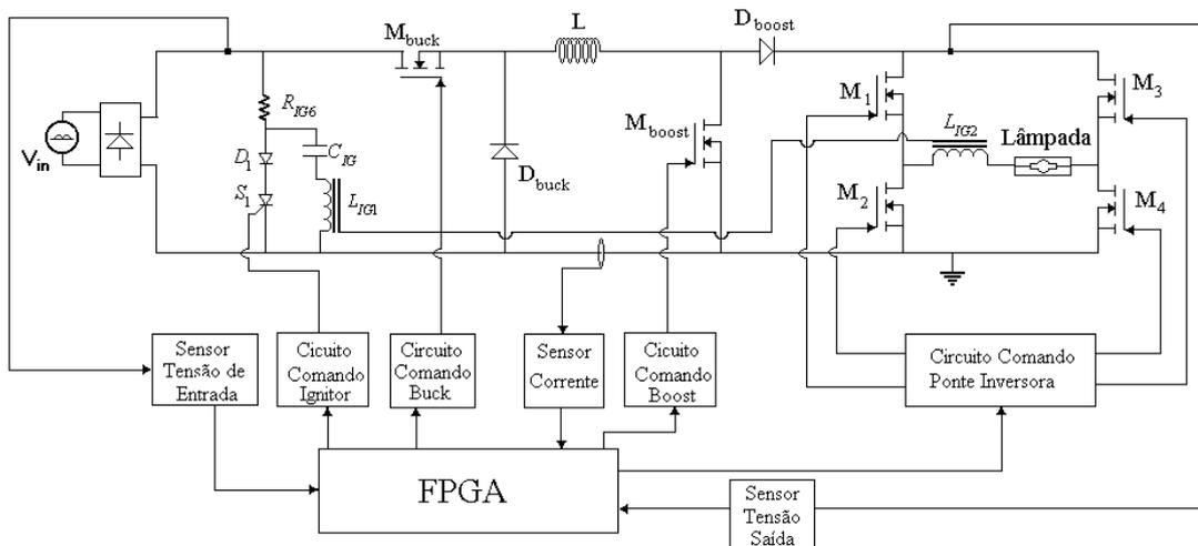
**Figura 4.1 - Diagrama com os circuitos dos estágios de potência Reator Eletrônico.**
