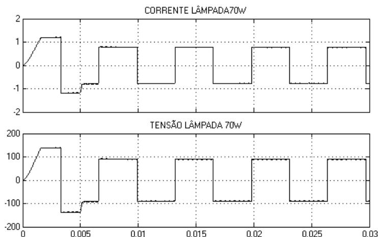
**Figura 6.4-Simulação das Etapas de Aquecimento e Regime Permanente para Lâmpada de 70W.
