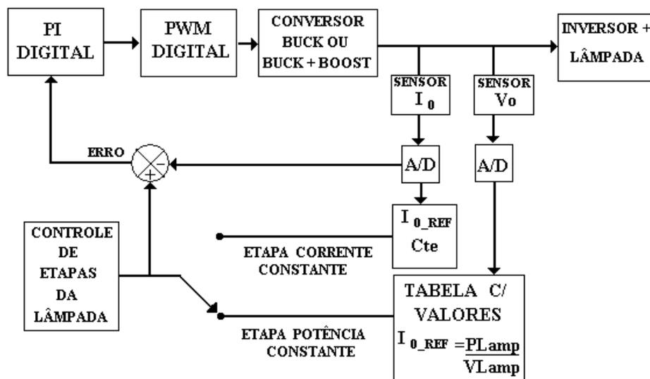
Figura 5.1- Diagrama de blocos do controle utilizado.
