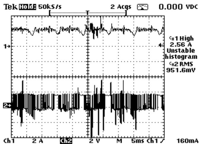
**Figura 6.49 — Etapa 2 (Corrente Constante): Corrente indutor (superior) e Tensão dos pulsos disparo Chave Buck (inferior) do reator para uma lâmpada à vapor de sódio de 150W. (1A/div;2V/div; 5ms/div).**
