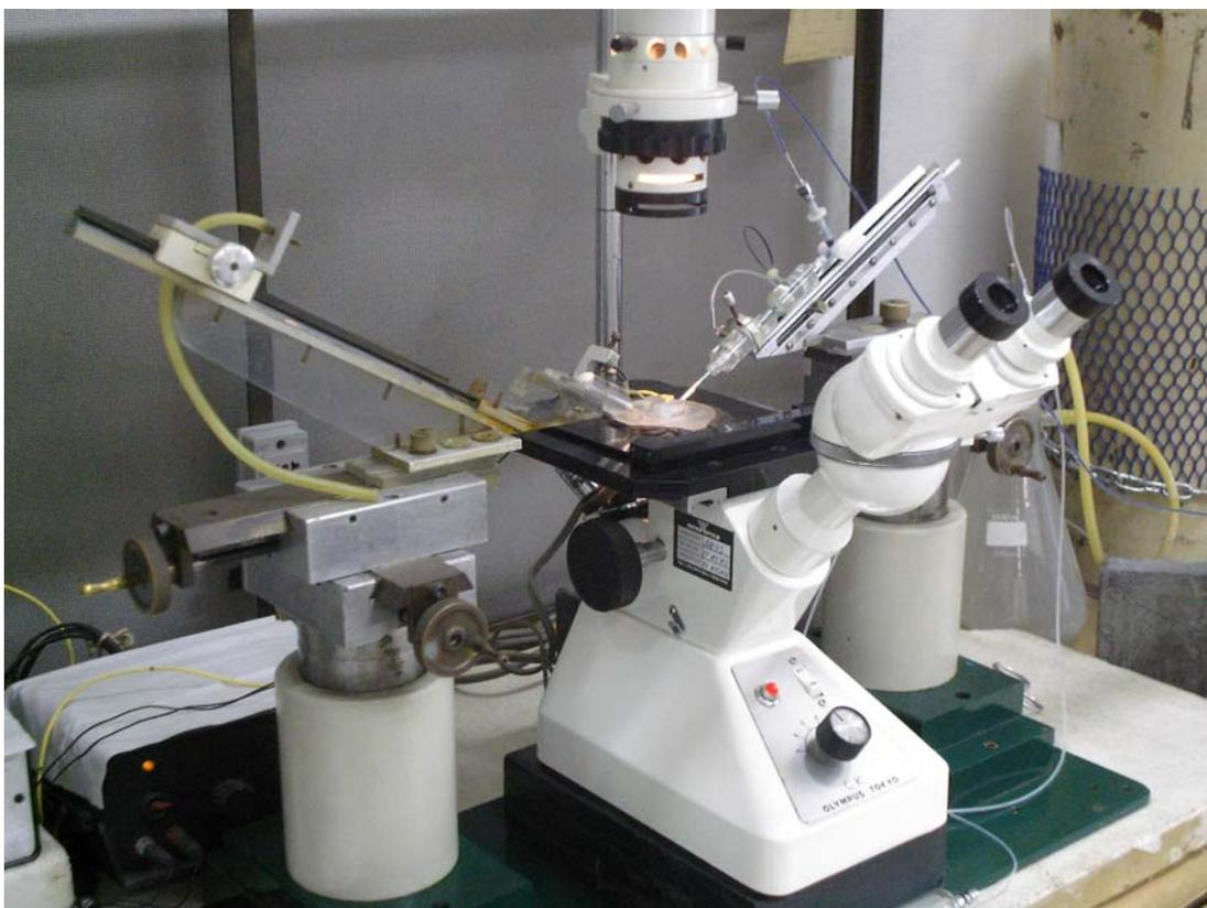
Figura 2. Equipamento de microperfusão
