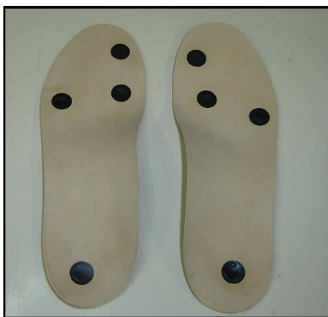
Figura 3.17 – Localização dos transdutores em uma palmilha.
