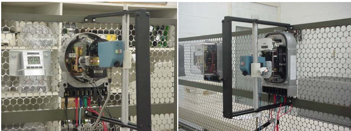
Figura 3.97 – Sensor de voltas de disco para medidores tipo indução.
