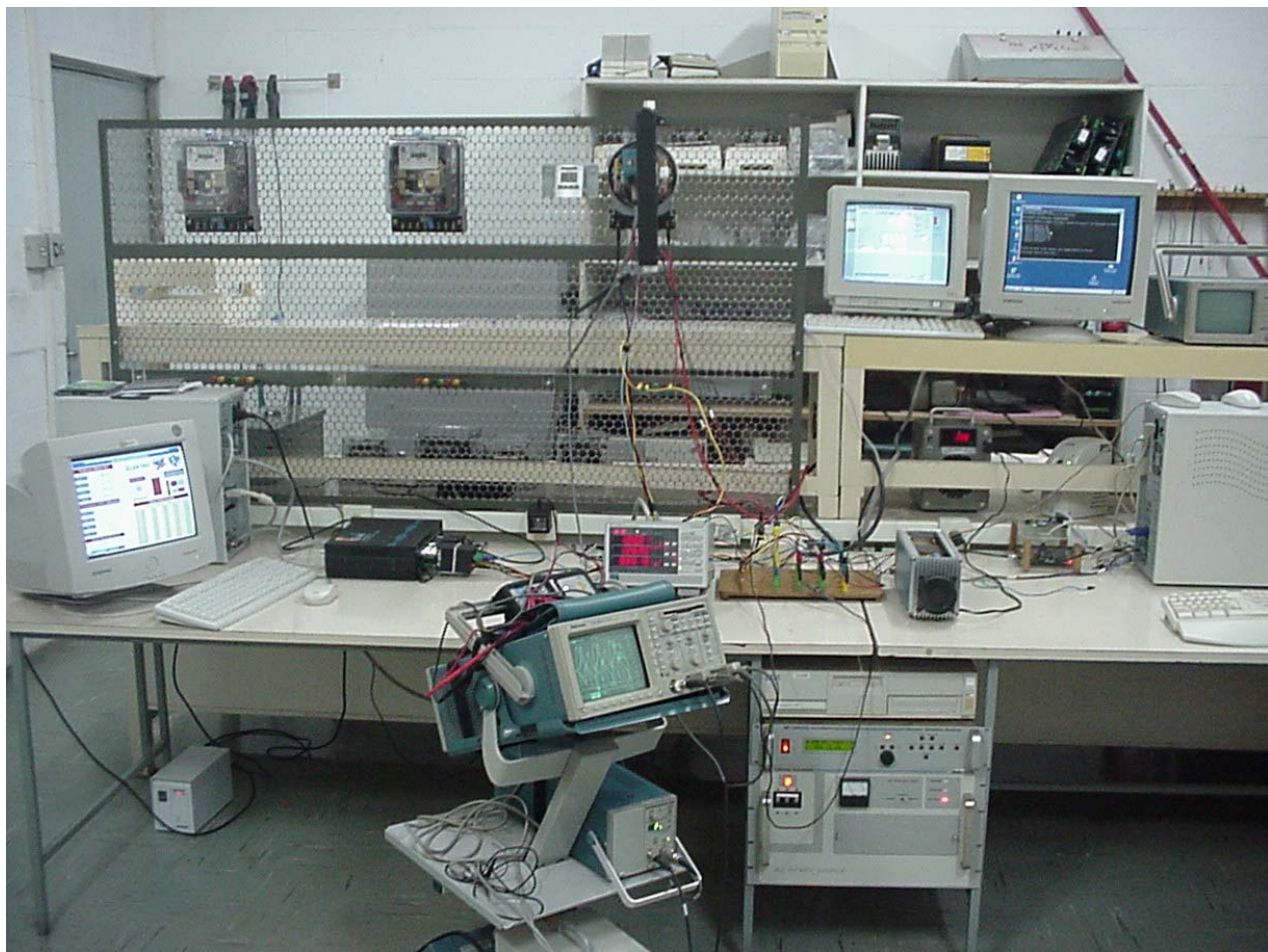
Figura 3.101 – Fotografia do arranjo laboratorial para ensaio dos medidores de energia tipo indução.
