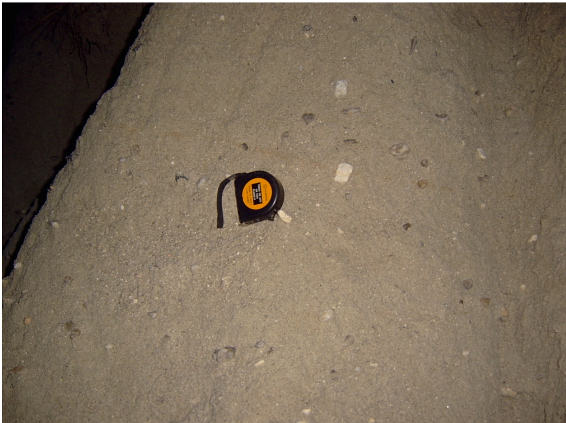
Fotografia 6: Detalhe da fácies D, arenito grosso a conglomerático maciço com seixos e grânulos dispersos.
