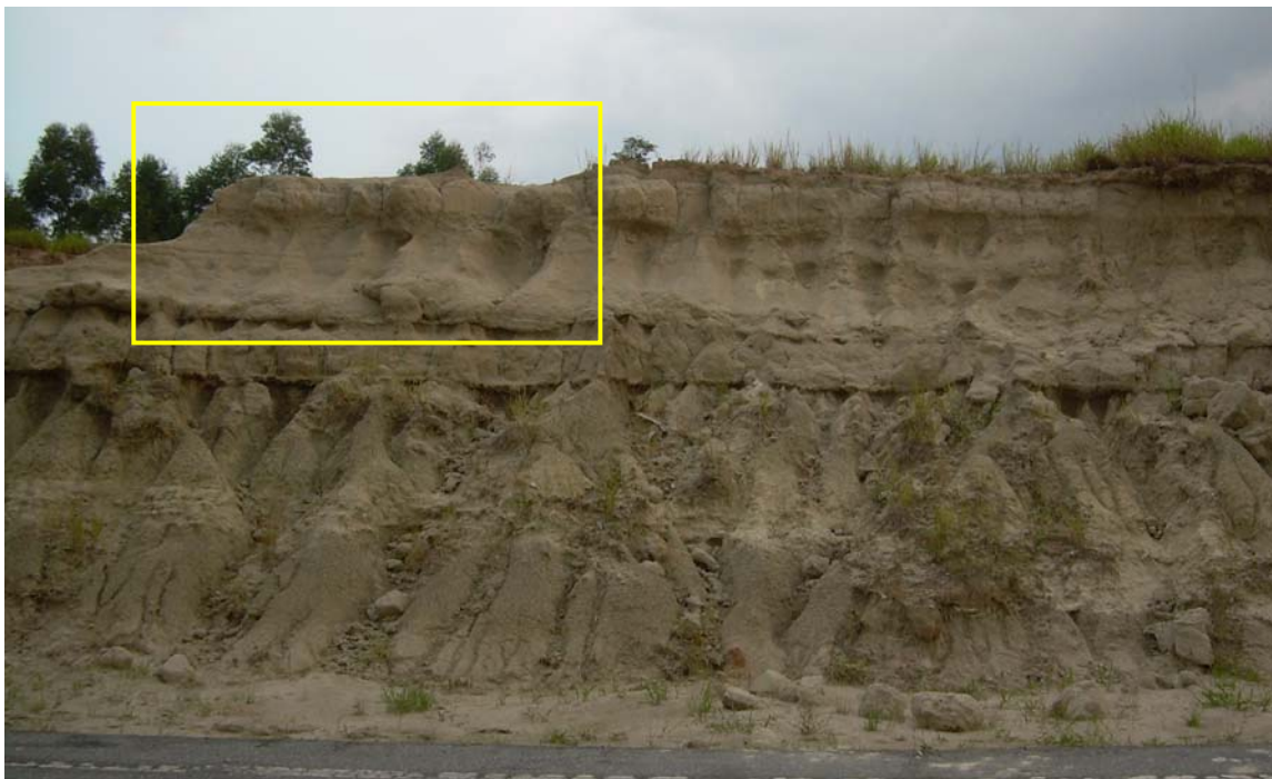
Fotografia 12: Camadas tabulares de arenito médio maciço da fácies H no topo do afloramento 2. O quadrado amarelo representa o detalhe mostrado na fotografia 13.
