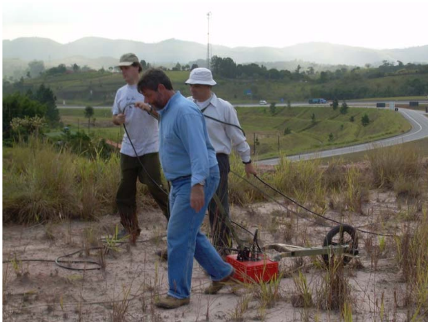
Fotografia 1: Foto da aquisição das linhas de GPR, onde observa-se a ferramenta de aquisição e a equipe trabalhando no levantamento de uma das linhas, que neste caso está sendo realizado com a antena de 400 MHz.
