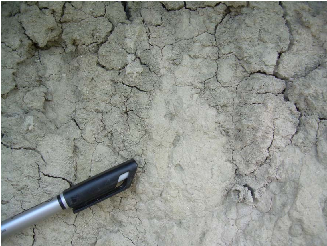
Fotografia 15: Siltito maciço com pequenas perfurações preenchidas pelo próprio siltito.
