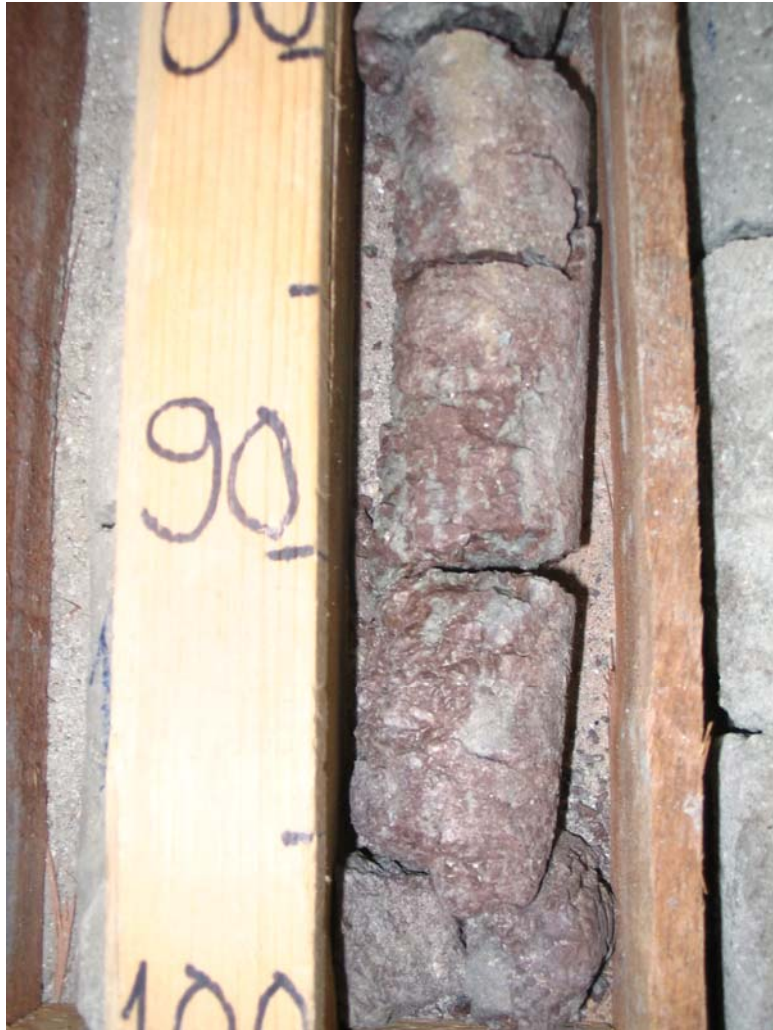
Fotografia 25: Detalhe do aspecto variegado e blocoso do siltito maciço da fácies III.
