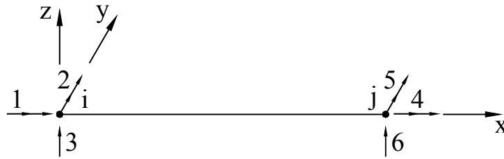
Fig. IV-1 Graus de liberdade do elemento de grelha.
