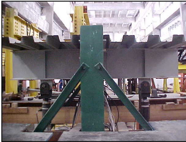
Fig. III-4 Configuração do ensaio para a fase anterior à cura do concreto.
