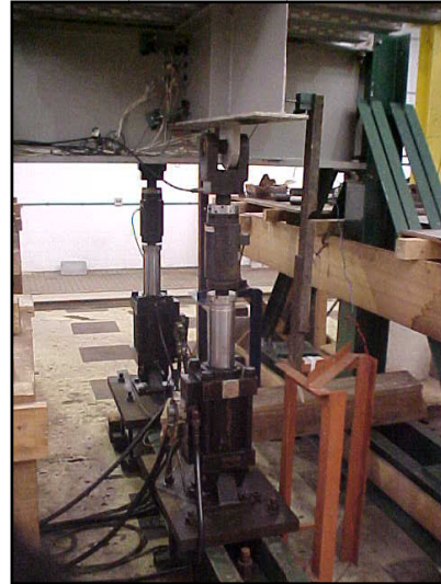
Fig. III-4 Configuração do ensaio para a fase anterior à cura do concreto.
