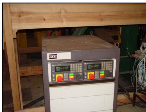
Fig. III-11 Equipamentos constituintes do sistema de aquisição dos sinais e controlador dos atuadores hidráulicos (CAH).
