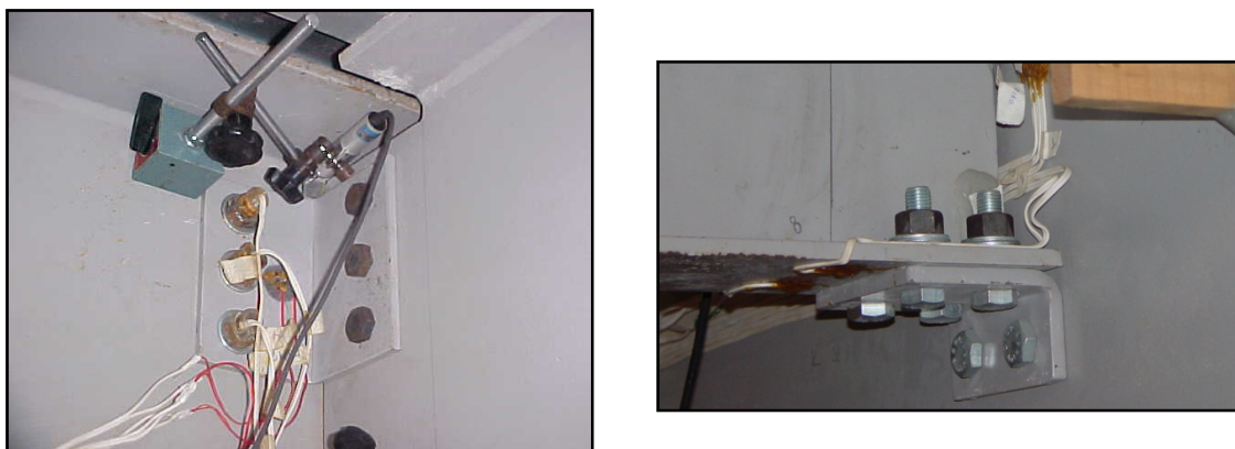
Fig. III-9 Medição da carga nos parafusos e do nível de tensões nas cantoneiras e mesas inferiores das vigas secundárias.
