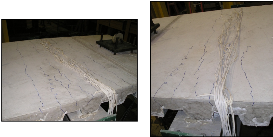
Fig. III-19 Estado de fissuração estabilizado e extensão das fissuras: ligação 1(a).
