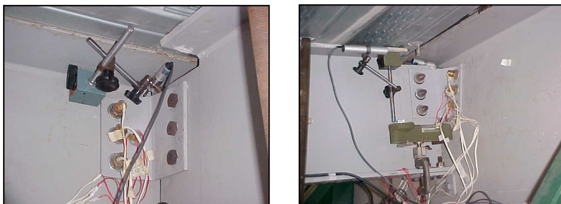
Fig. III-33 Mecanismo plástico de deformação das cantoneiras de alma.
