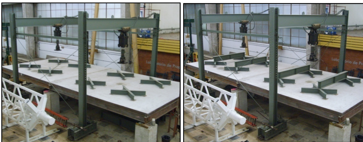
Fig. V-45 Montagem do sistema de carga: cruzetas e vigas de distribuição.
