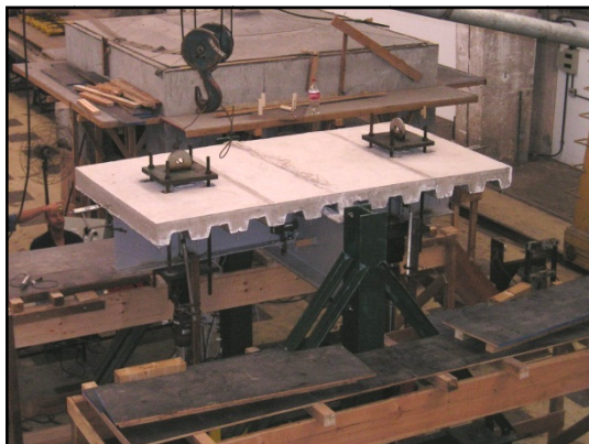
Fig. III-5 Configuração do ensaio para a fase posterior à cura do concreto.
