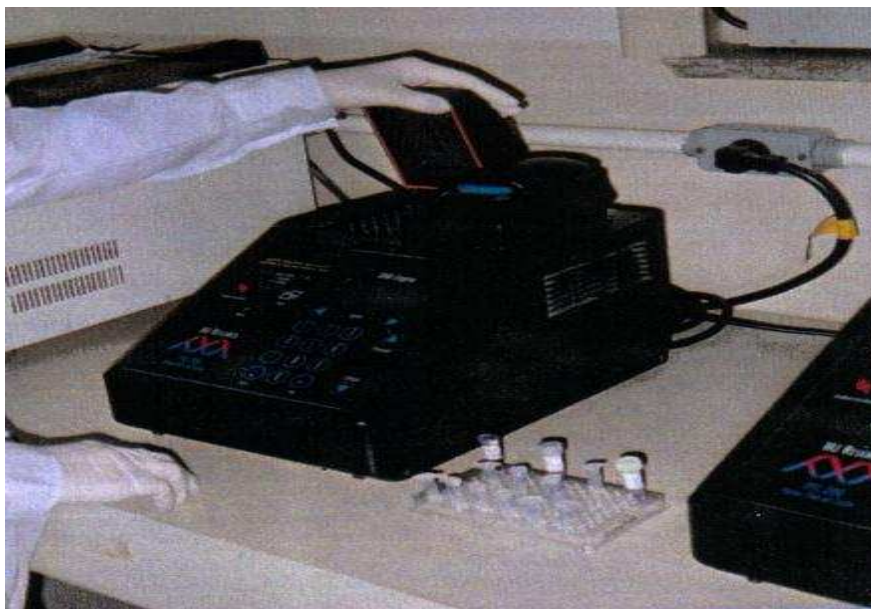
FIGURA 3 - Amostras sendo colocadas no termociclador onde ocorrerão as etapas da PCR: desnaturação, anelamento e extensão.
