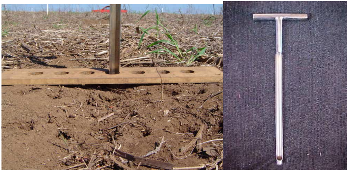
FIGURA 4 – VISUALIZAÇÃO DA COLETA DE AMOSTRAS DE SOLO COM A INCLUSÃO DA LINHA DE SEMEADURA (DIREITA) E TRADO DO TIPO CALADOR (ESQUERDA) UTILIZADO PARA AMOSTRAGEM.
