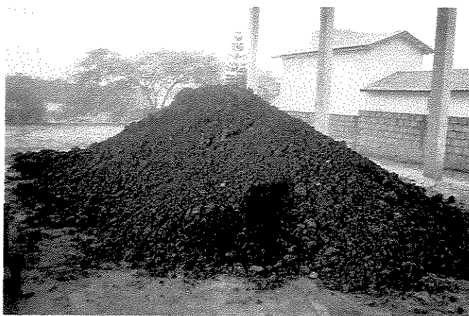
Figura 21 – Aspecto do lodo da ETA Cubatão após 3 meses estocado no pátio da cerâmica.
