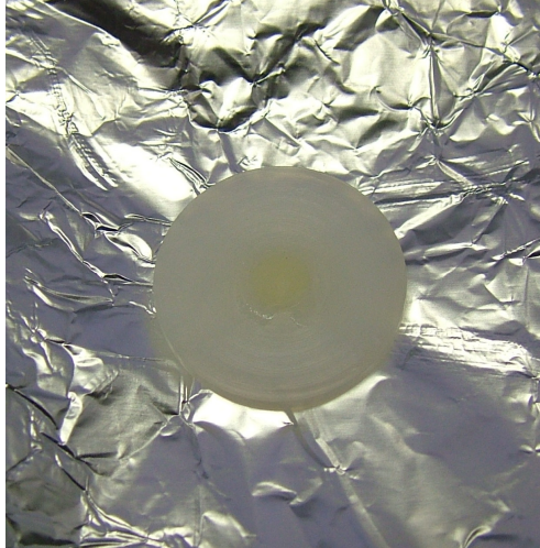
Figuras 14 e 15- Corpo-de-prova sendo protegido pelo papel alumínio e armazenado em recipiente isento de luz.
