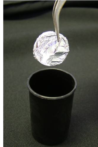
Figuras 14 e 15- Corpo-de-prova sendo protegido pelo papel alumínio e armazenado em recipiente isento de luz.
