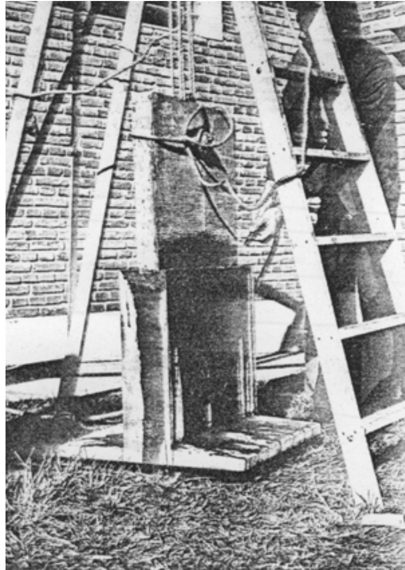
foto 129 Ensaio de retirada do suporte fixado com areia vibrada.
