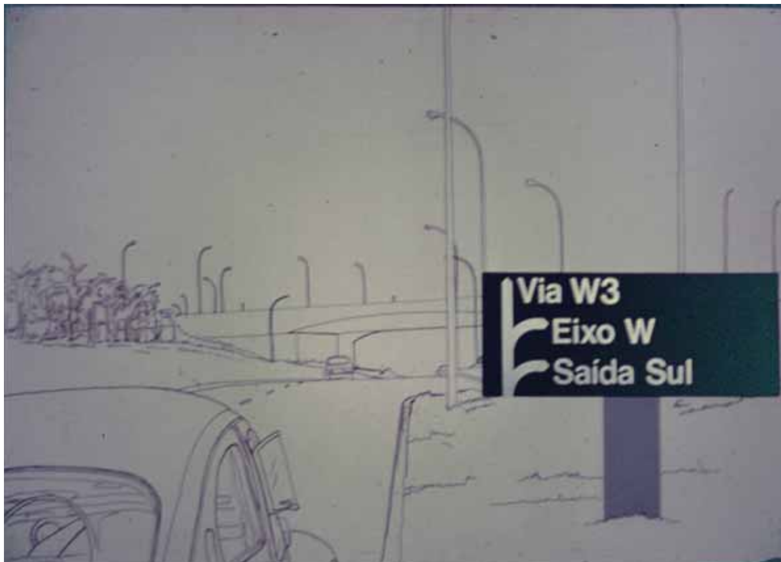
foto 149 Layout final, Peça indicativa horizontal. Vista da via de acesso aos trevos localizados no final da asa sul. O trabalho foi feito utilizando o vinil reflexivo Fonte: Antonio Danilo.
