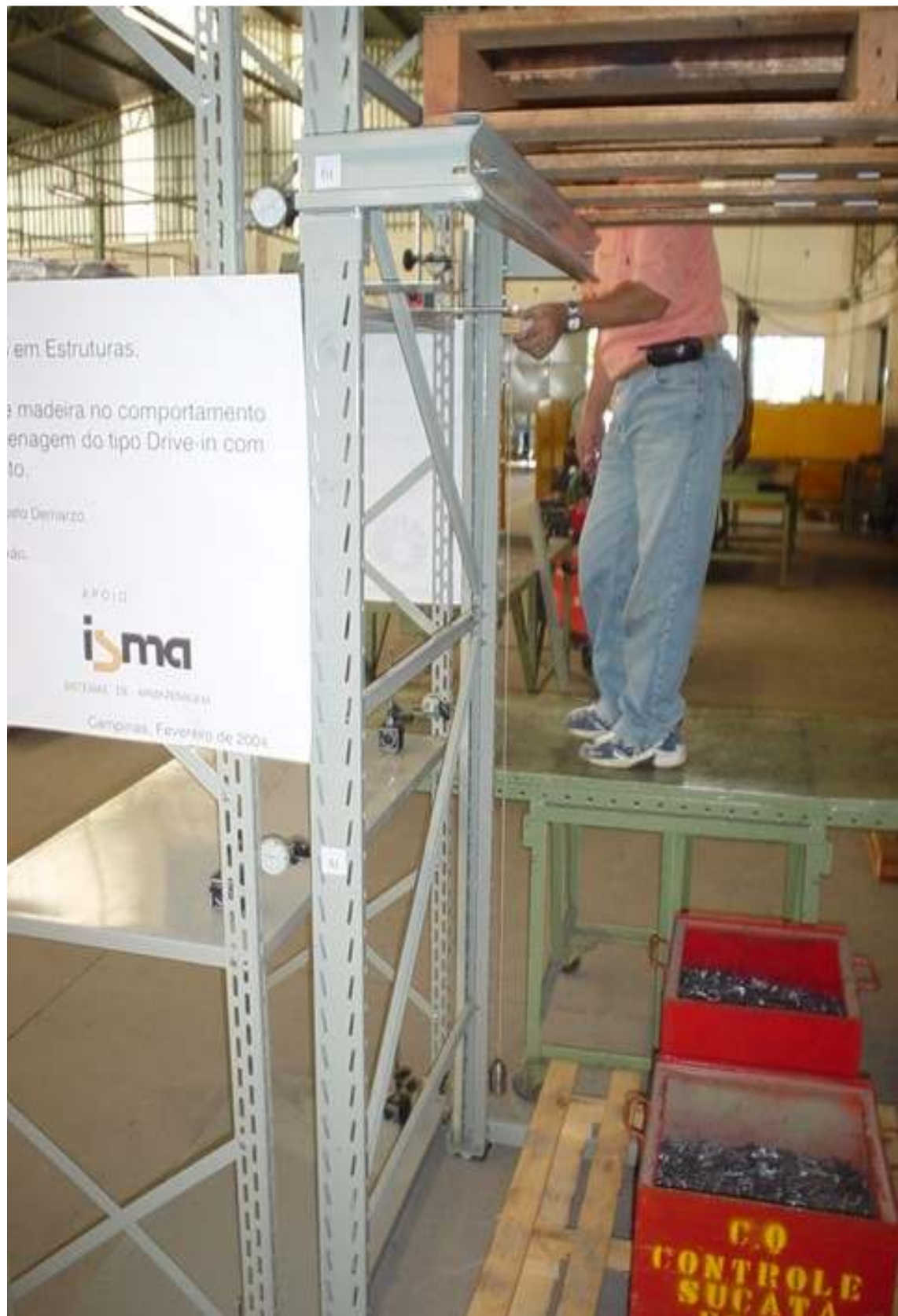
Figura 62 – Prumada dos pórticos
