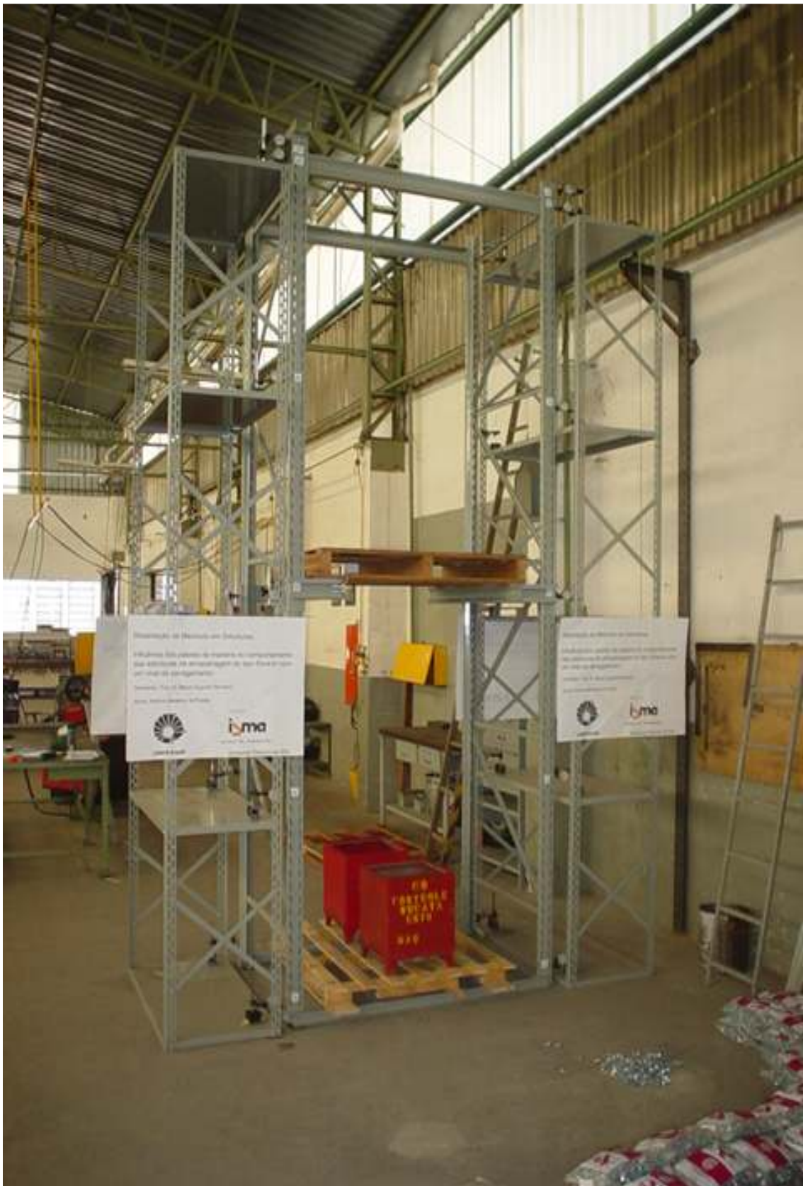
Figura 59 – Pórticos e estruturas para apoio dos relógios comparadores
