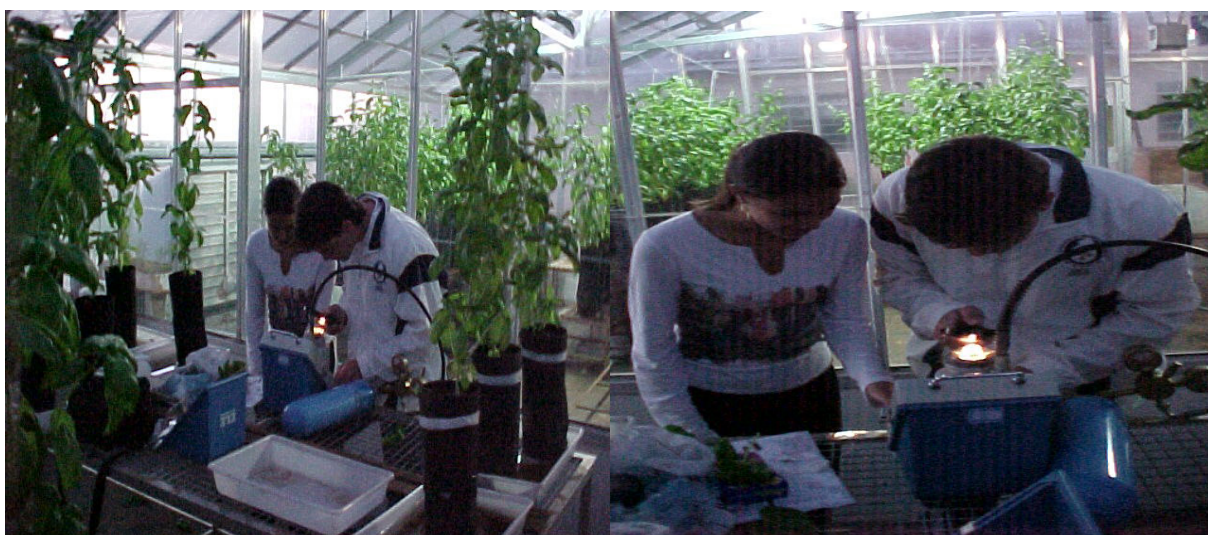
Foto 4: Detalhes da medição do potencial de água das plantas utilizando-se a câmara de pressão.
