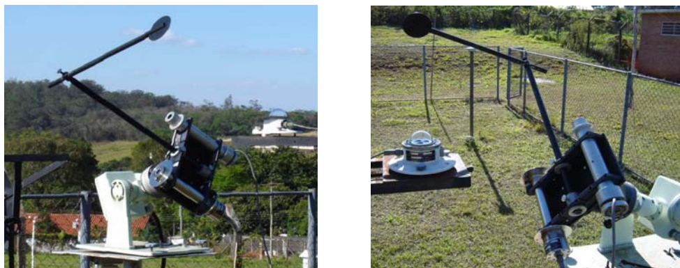
Figura 1. Pireliômetro Eppley – Detector da radiação solar direta na incidência
