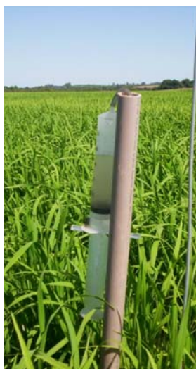
FIGURA 4. Coletor de solução do solo instalado a campo. Restinga Seca II, safra 2005/06.
