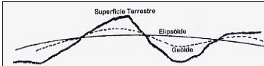
Figura 4. Superfície da Terra, geóide e elipsóide de revolução.
