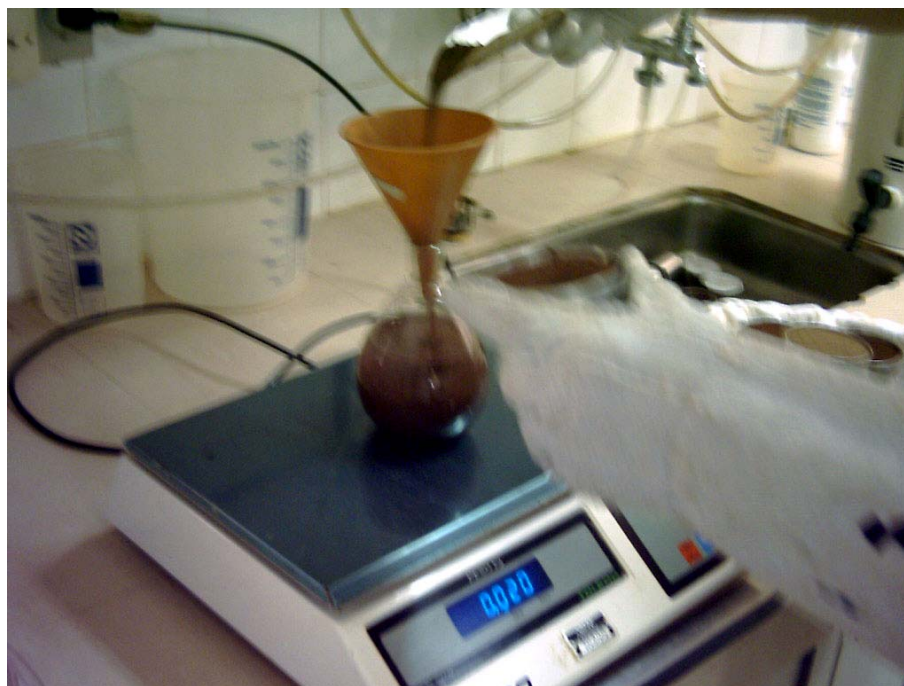
Figura 7. Uma das etapas da determinação da massa específica dos sólidos.
