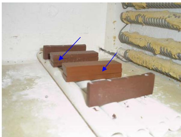
Figura 17. Queima dos corpos-de-prova para a análise de coração negro. Setas azuis indicando os corpos analisados.
