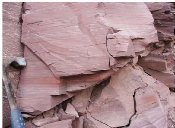
Figura 5. Aspecto das amostras oriundas da mina Granusso: (a) frente de lavra com aproximadamente 22 metros de profundidade indicando os níveis GRM e GV; (b) foto de detalhe da rocha de coloração roxa e estrutura maciça (GRM) localizada na base da mina; (c) detalhe do nível GV mostrando sua estrutura variegada e laminação fina localizada acima do nível GRM. A transição entre os dois níveis é gradual (GRM = Granusso Roxo Maciço; GV = Granusso Variegado).
