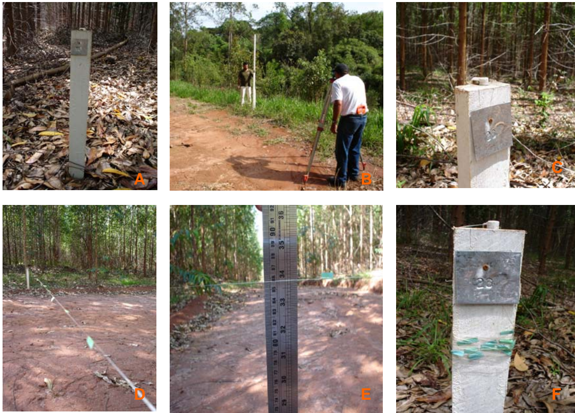
Figura 6 – (A) Identificação das estacas; (B) Nivelamento dos pares de estaca; (C) Peça plástica para prender o fio de nylon; (D) Fio demarcado com fita adesiva colorida; (E) Régua milimetrada e (F) Fio enrolado na estaca
