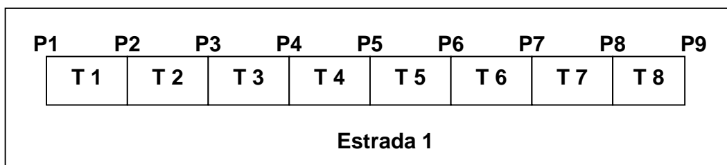
Figura 5 – Exemplo do método adotado para a subdivisão das estradas em perfis (P) e trechos (T)
