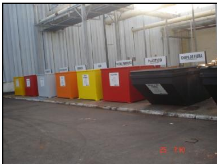
Figura 10 - Acondicionadores da área de processamento de chapas - capacidade 5m³.
