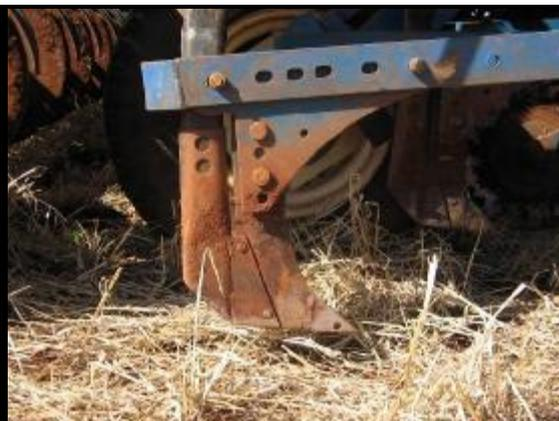
**Figura 21 A** Mecanismo sulcador tipo haste.
