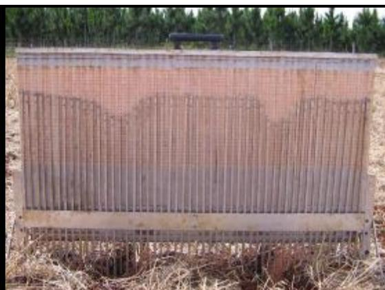
**Figura 25 A** Perfilômetro após a retirada do solo
