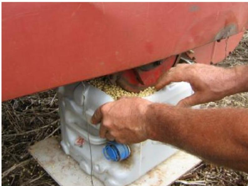
**Figura 5** Coleta dos grãos no final do transportador helicoidal de grãos limpos.
