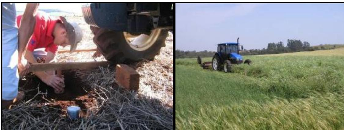
**Figura 8 A** Coleta de solo com anel volumétrico. **Figura 9 A** Rolagem do consórcio Aveia e nabo.
