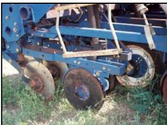
**Figura 22** Mecanismo sulcador disco duplo linha.
