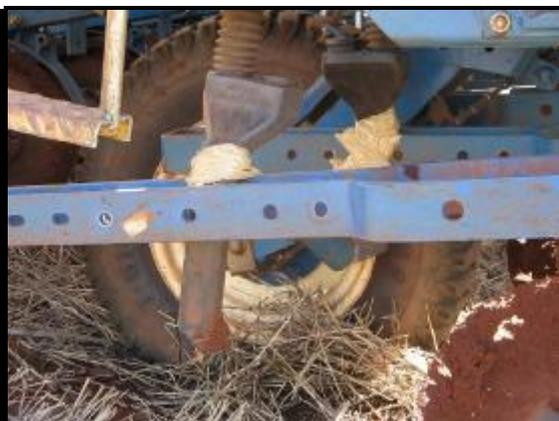
**Figura 23 A** Conductor de fertilizante fixado na linha.
