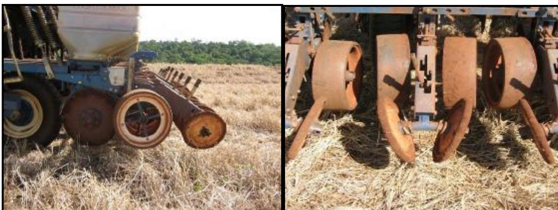
**Figura 18 A** Mecanismos sulcador, controle de **Figura 19 A** Regulagem do compactador.
