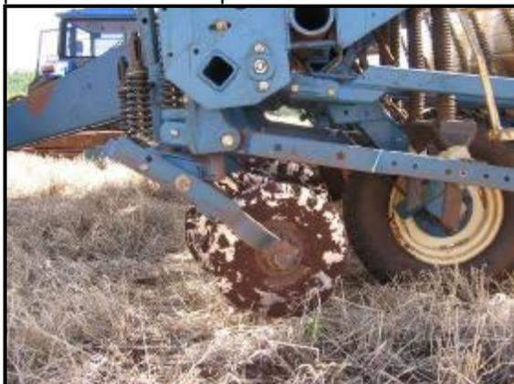
**Figura 20 A** Disco de corte de palha.
