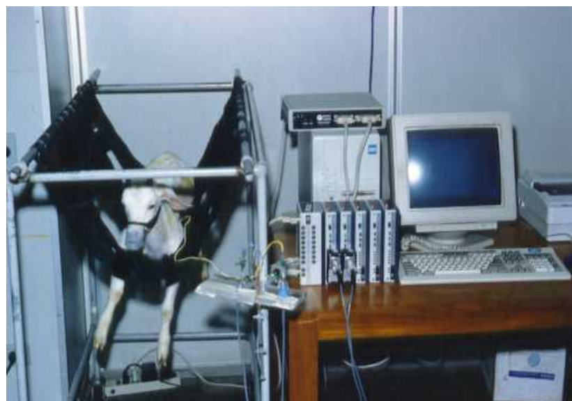
Figura 10. Animal consciente e posicionado para leitura de pressões e ajuste percutâneo da sobrecarga diastólica.
