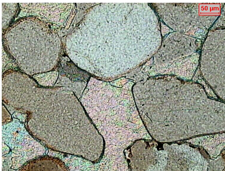
Foto 6.14. Presença de cimento carbonático entre os grãos apresentando sinais de dissolução (Amostra CAM016 – Nicóis //).
