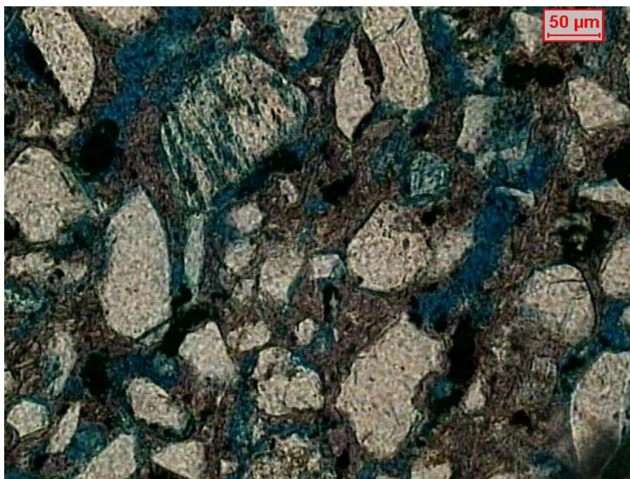
Foto 6.17. Dissolução de grãos de feldspato, e presença de argilas formando matriz ao redor dos grãos do arenito (Amostra CAM002 Nicóis //).
