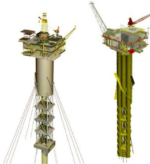
**Figura 2.10 – Exemplo esquemático de plataformas *Truss* e *Cell Spar* [25].**
