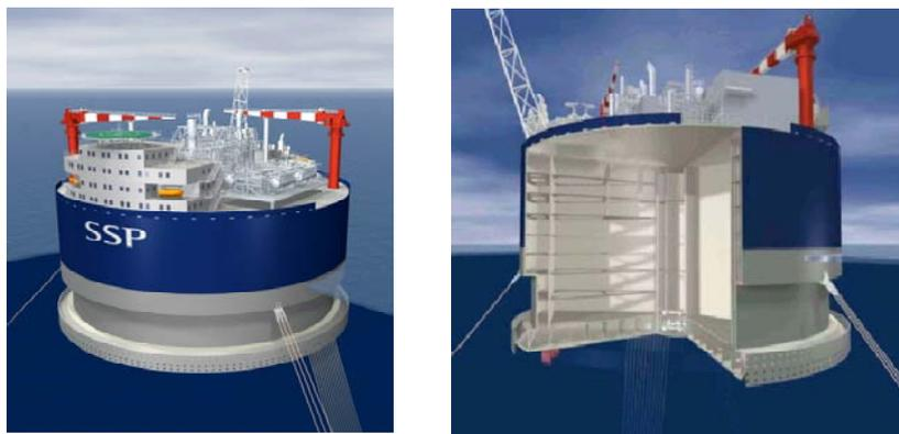
Figura 2.12 – Modelo esquemático da SSP Piranema
