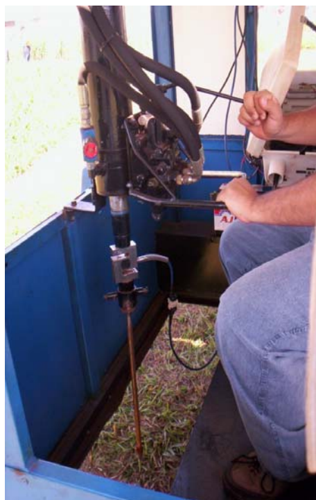
Figura 9 - Penetrômetro hidráulico eletrônico, equipado com sistema DGPS, construído por Santos & Lanças (1998).
