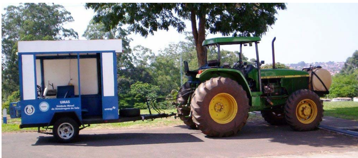
Figura 8 - Unidade Móvel de Amostragem de Solo (UMAS) utilizada para o levantamento de dados georreferenciados.
