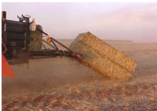
Figura 6: Fardo prismático do palhiço (Fonte: RIPOLI, 2002).
