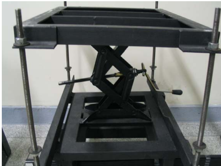
Figura 8 – Estrutura de sustentação da plataforma de força do assento com macaco mecânico e quatro guias
