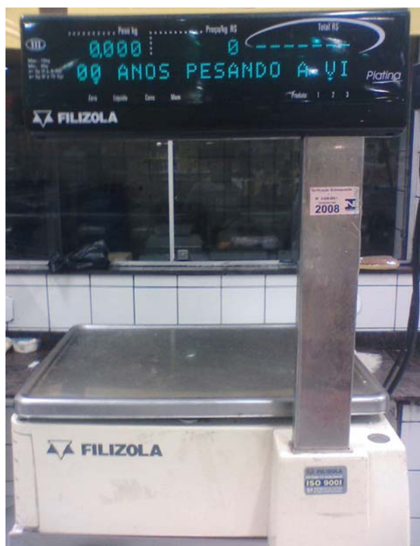
Figura 3 – Balança digital Filizola usada para verificar os pesos das anilhas utilizadas na calibração das plataformas de força.
