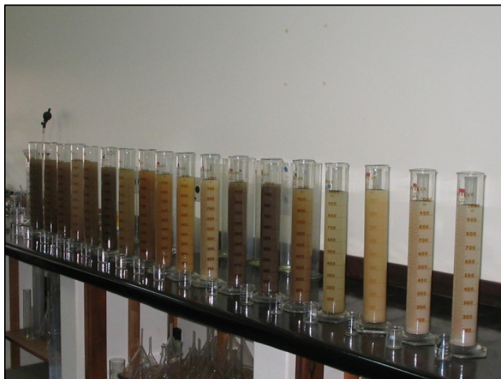
FIGURA 12. Sedimentos lamosos em provetas para a pipetagem. Da esquerda para a direita, amostras 1 a 18.
