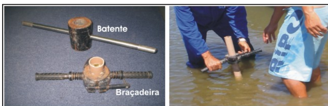
FIGURA 10. Testemunhador a percussão (a esquerda) e retirada do tubo de PVC (a direita).
