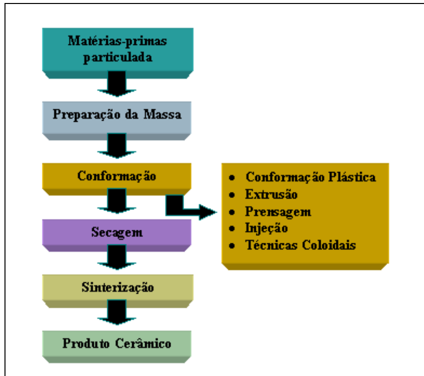
Figura 1 – Principais etapas usualmente envolvidas no Processamento de Materiais Cerâmicos (PANDOLFELLI, 2000).
