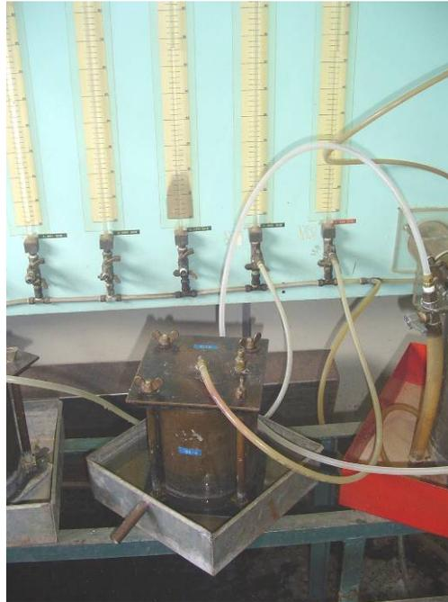
**Figura 4.10**– Ensaio de permeabilidade com carga variável em andamento.
