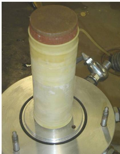
**Figura 4.14** – Corpo de prova protegido por membrana de látex
