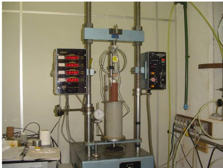
**Figura 4.16** – Ensaio de resistência a compressão simples em andamento.
