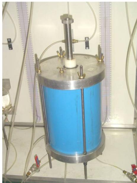
**Figura 4.4** – Equipamento para realização do ensaio de condutividade hidráulica em permeâmetro de parede flexível.
