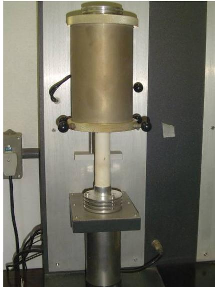
**Figura 4.8**– Ensaio de análise térmica diferencial (ATD) em andamento.
