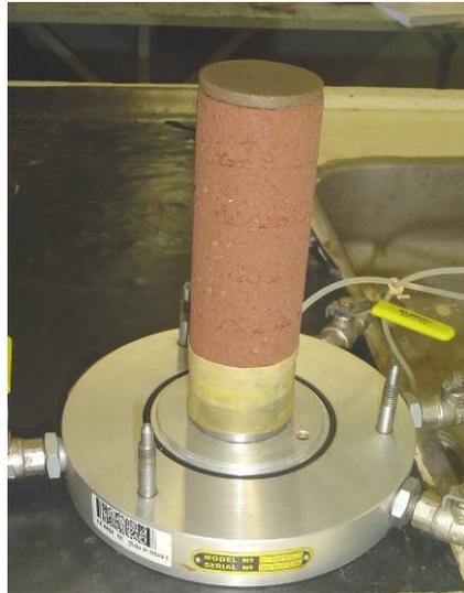
**Figura 4.13** – Colocação do corpo de prova sob a base da câmara triaxial
