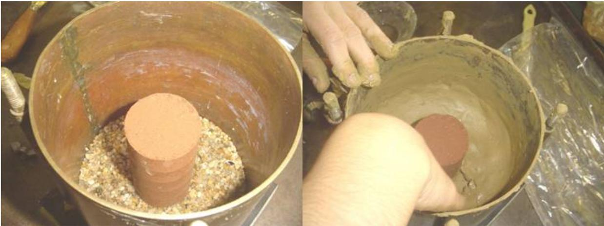
**Figura 4.9**– Seqüência de montagem do ensaio em permeômetro de parede rígida
