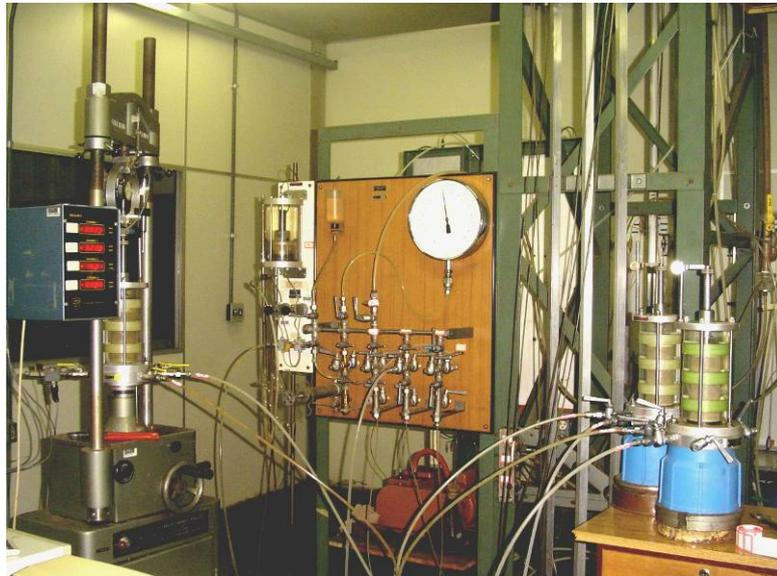
**Figura 4.5** – Equipamento para realização do ensaio triaxial.
