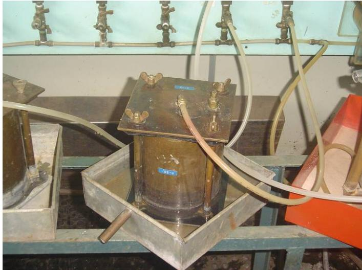
**Figura 4.3** – Equipamento para realização do ensaio de condutividade hidráulica em permeâmetro de parede rígida.
