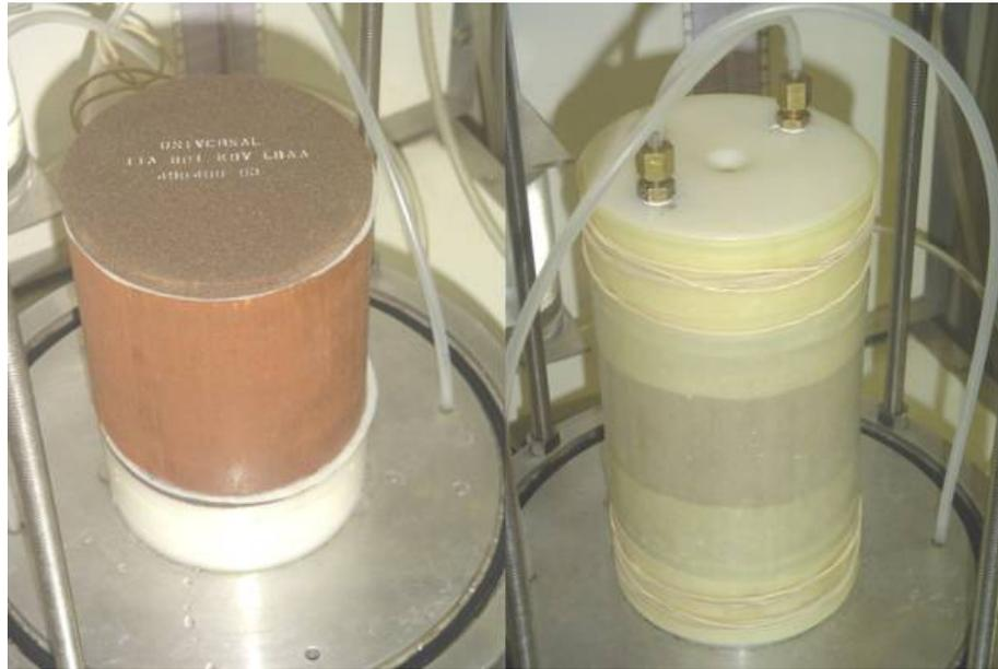
**Figura 4.12**– Seqüência de montagem do ensaio em permeâmetro de parede flexível.
