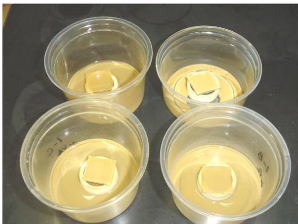
**Figura 4.7**– Preparo das lâminas para o ensaio de difratometria de Raio X.
