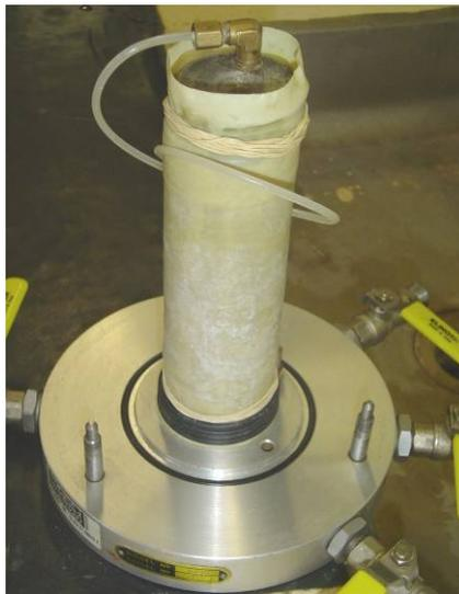
**Figura 4.15** – Corpo de prova devidamente fixo com o-rings e elásticos
