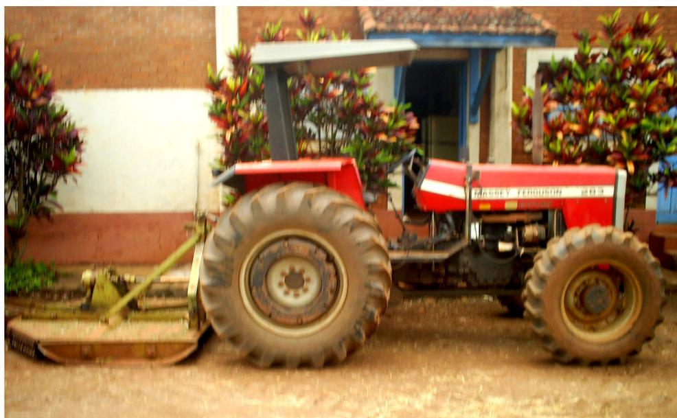
Figura 34 - Trator agrícola MF 283E roçadora.
