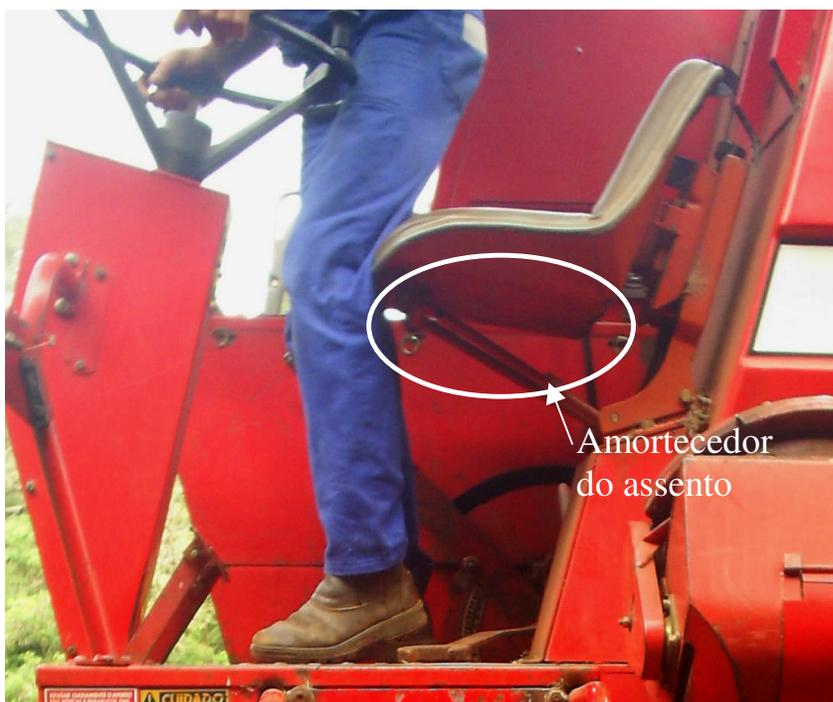
Figura 33 - Exemplo de amortecedor do assento de máquina agrícola.
