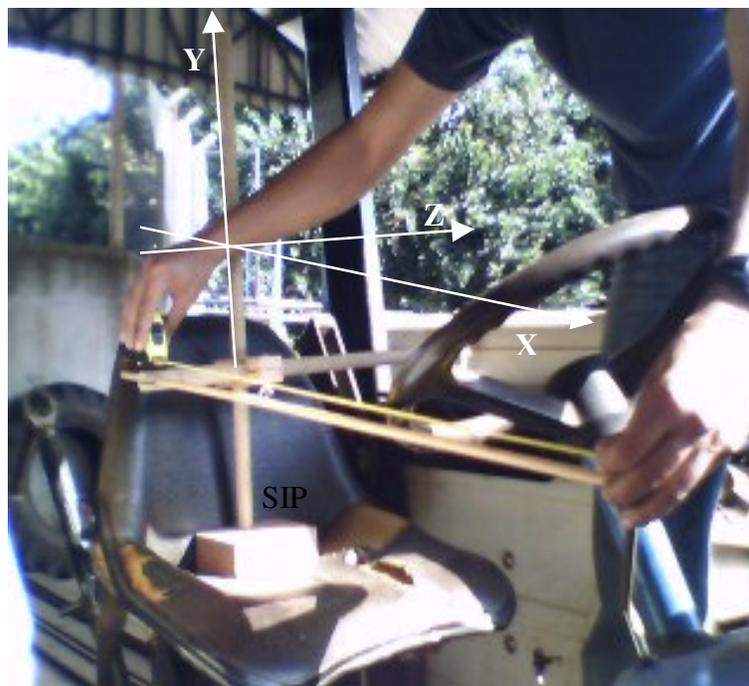
Figura 32 - Dispositivo de madeira (SIP) em medição.
